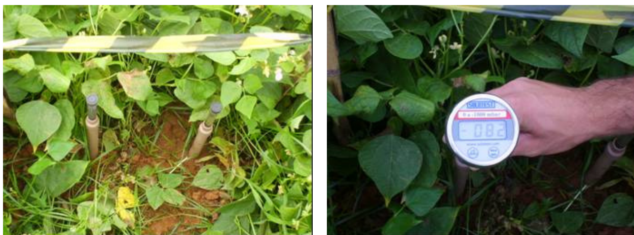
Figura 6. Tubos tensiométricos instalados na área experimental e tomada de leitura com tensímetro digital.
