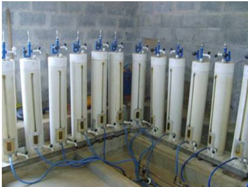
Figura 3. Irrigômetros modificados que foram conectados aos 12 lisímetros de lençol freático constante.
