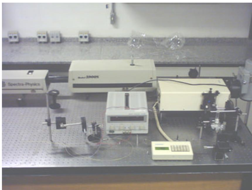
**Figura 6.1:** Esquema da bancada óptica com o sistema Raman.
