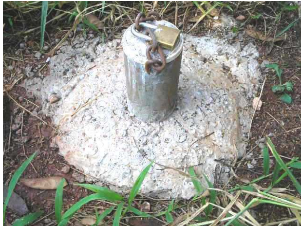
Figura 8 – Ponto 26, poço de coleta construído ao lado do terreno da Petrobras
