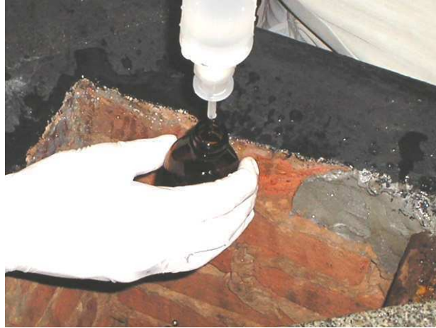
Figura 5 – Uso do coletor para poço – coletor com dosador para pequenos recipientes
