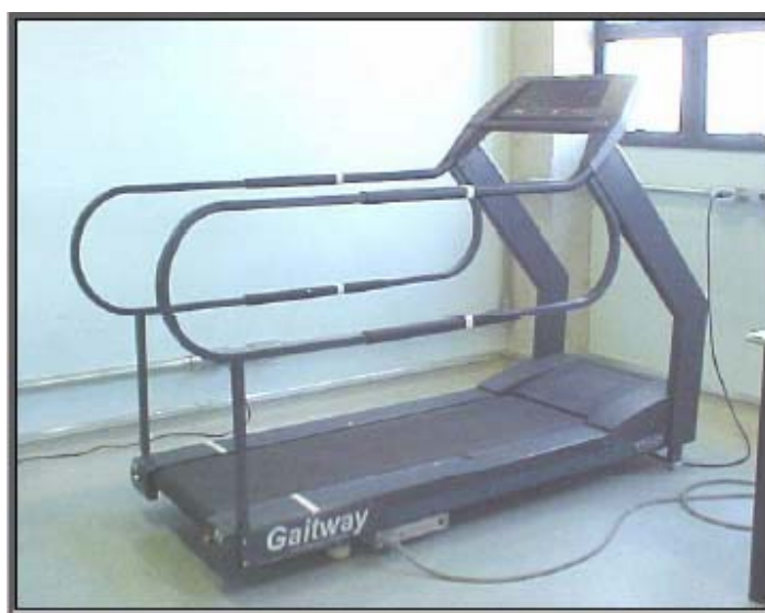
Figura 15 – Esteira rolante instrumentada do Sistema Gaitway™.
