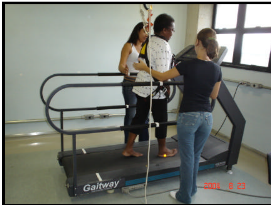
Figura 4: Idoso andando na esteira rolante instrumentada do Sistema Gaitway™, durante a coleta de dados. Note o sistema de segurança utilizado durante a coleta dos dados tanto para indivíduos idosos quanto para indivíduos do grupo controle. Note também os terapeutas
