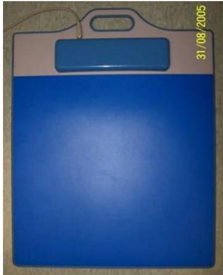
**Figura 6:** Plataforma de força
