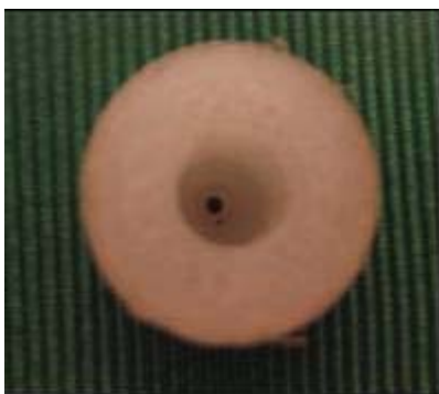
Figura 7. Peça construída em Nylon para permitir a fixação do LED ao torno.
