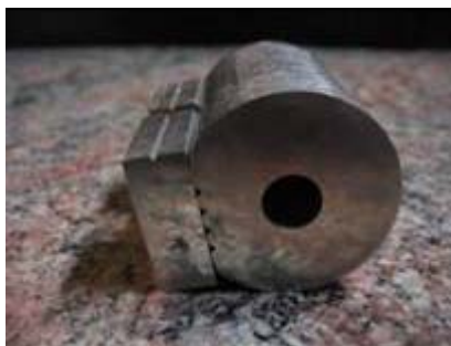
Figura 8. Peça construída em aço inoxidável que permite o polimento simultâneo e preciso de duas fibras ópticas.
