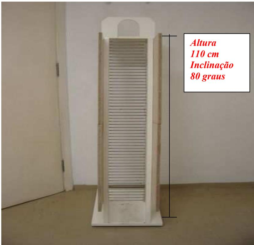
**Figura 2 - Equipamento utilizado para o exercício resistido. O equipamento foi confeccionado em madeira com degraus de ferro. A altura do equipamento é de 110 cm com inclinação de 80° (Hornberger e Farrar, 2004).**
