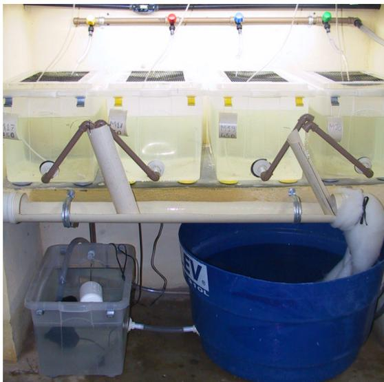
Figura 7 – aquários com sistema de recirculação de água.
