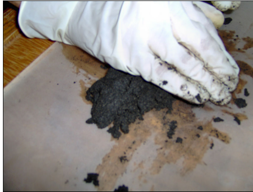
Figura 6.1 – Ensaio de plasticidade do lodo de esgoto.
