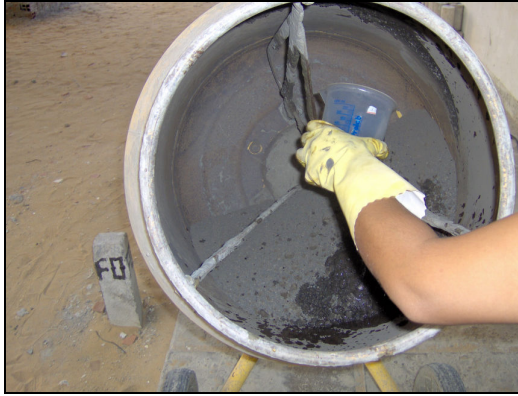
Figura 5.10 – Betoneira para mistura da massa cerâmica.
