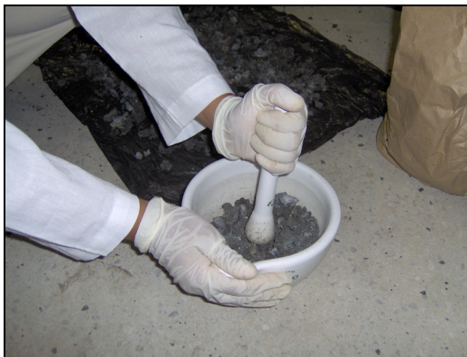
Figura 5.3 – Destorroamento das argilas.
