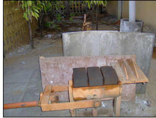
Figura 5.11 – Prensa manual para moldagem dos tijolos maciços.
