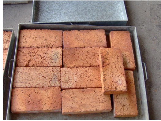
Figura 5.13– Tijolos com 20% de lodo depois da queima.
