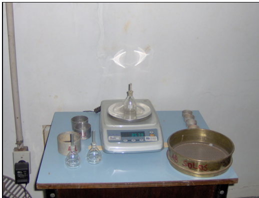
Figura 5.7 – Pesagem do picnômetro vazio.
