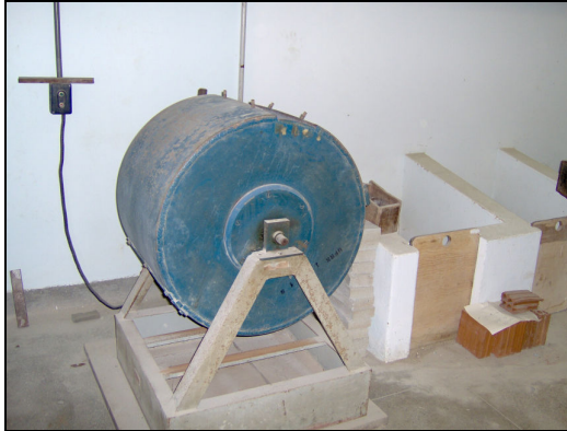
Figura 5.5 – Máquina de abrasão Los Angeles.
