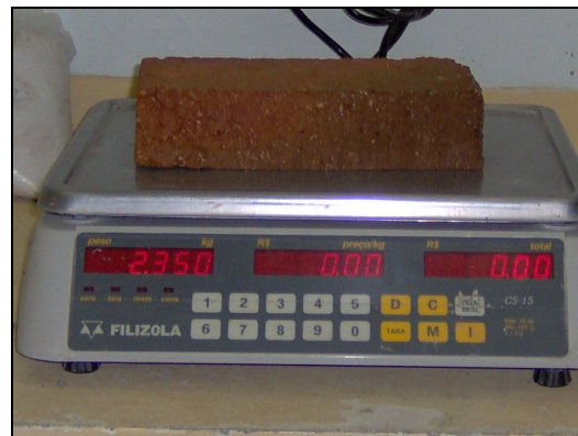
Figura 5.15 – Pesagem de tijolo úmido.
