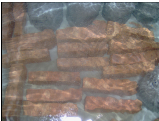
Figura 5.14 – Tijolos no tanque de água.
