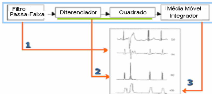
Figura 36: Etapas do algoritmo da detecção do complexo QRS
