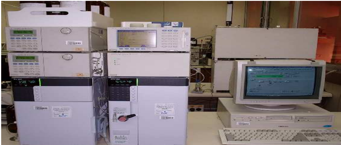
Figura 5 - Cromatógrafo líquido, fabricante Shimadzu com detector ultravioleta-visível (espectrofotométrico) com conjunto de diodos (DAD) completo usado em todos os requisitos da validação
