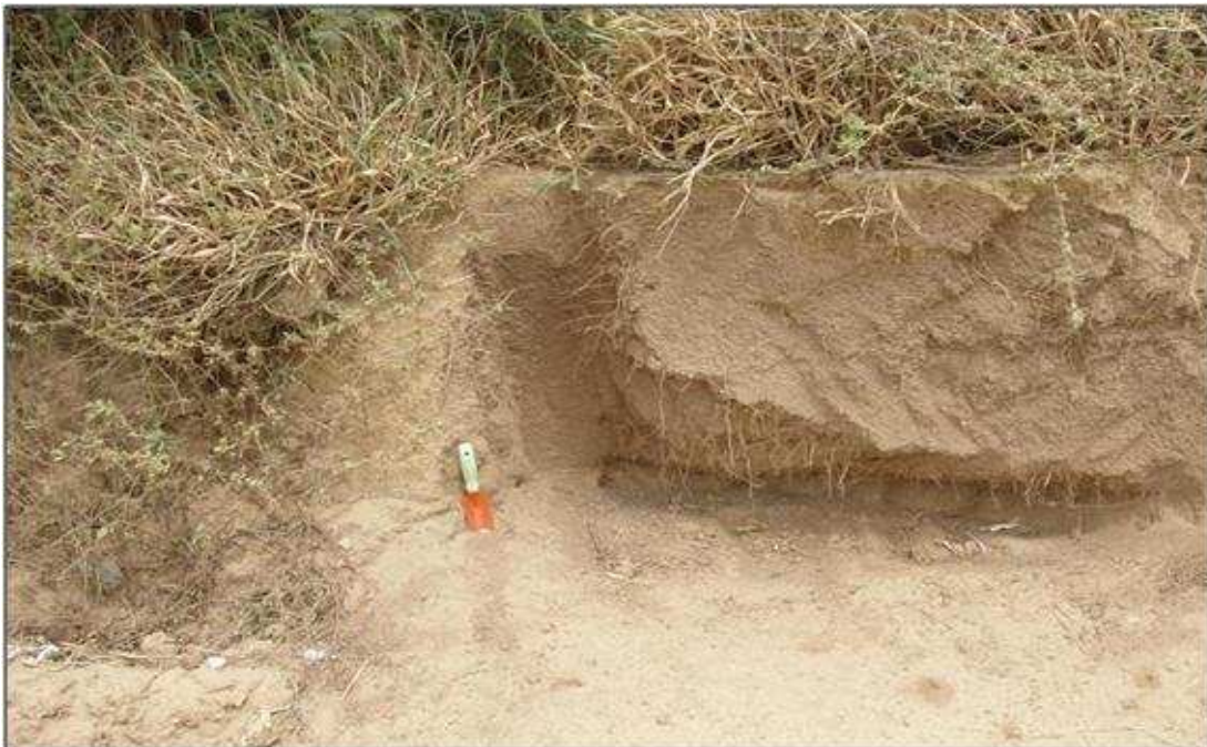
Foto 06: Perfil de um Regossolo localizado no bairro Dom Helder Câmara. Área de expansão urbana. (coordenadas UTM: 0774896 S / 9018968 W, 897m de altitude).
