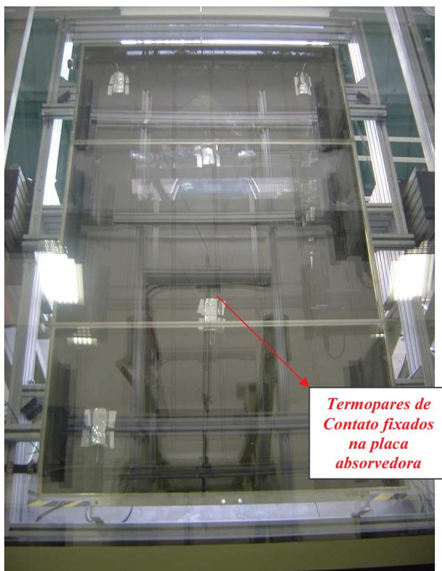
Figura 4.5: Detalhe da fixação dos termopares de contato
