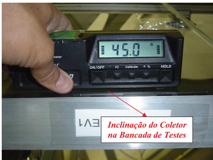
Figura 4.7.: Medida da inclinação do coletor na bancada de testes
