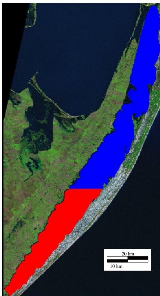
Figura 5.13 – Estágio inicial para a simulação de transporte. A região em vermelho indica uma concentração de 10 g/l para o poluente simulado e a região em azul a concentração é nula.
