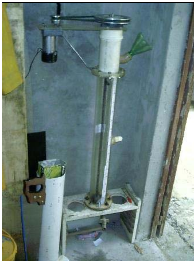
FIGURA 4.5: Cilindro utilizado para o teste do IVLA.
