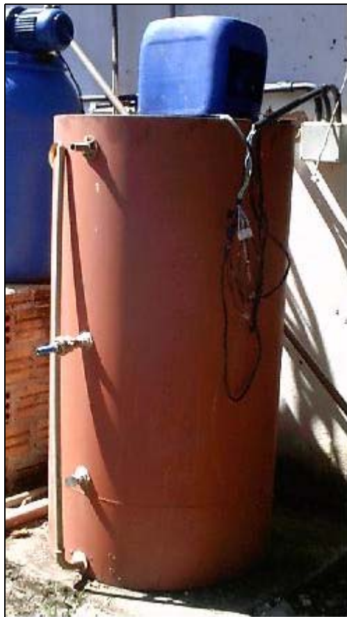
FIGURA 4.2: RSB em escala piloto utilizado para a pesquisa.
