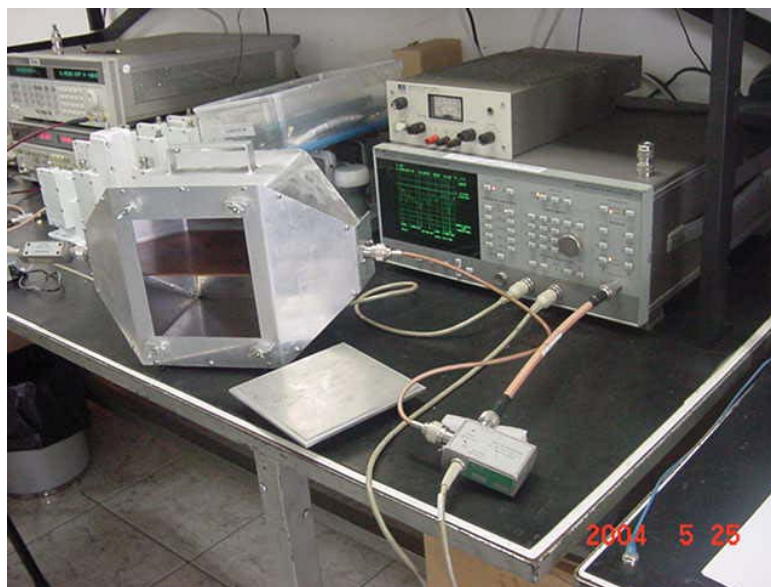
Figura 12 - Teste de resposta em frequência da Célula TEM com equipamentos Agilent.
