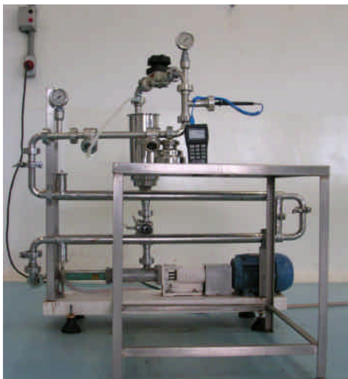
FIGURA 4.2 – Sistema membranar com o módulo da membrana cerâmica de microfiltração acoplado
