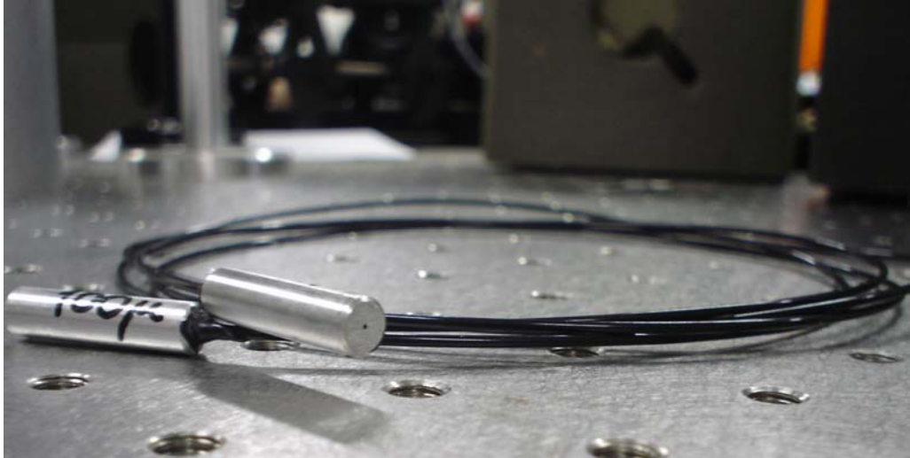
Figura 8: Detalhe da terminação mecânica acrescentada à extremidade das fibras ópticas.
