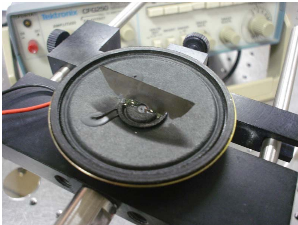
Figura 9: Atuador eletromecânico com lâmina de aço acoplada. Alto-falante com diâmetro de 55 mm, impedância de 8 \Omega e potência máxima de 250 mW.
