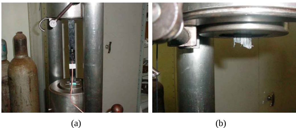
Figura 3.13 – Ensaio dos corpos-de-prova de compósitos de fibra de carbono com placas de alumínio nas extremidades: (a) vista frontal do corpo-de-prova antes do ensaio; (b) ruptura do corpo-de-prova.
