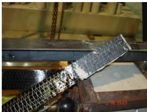
Figura 4.5 – Detalhe do descolamento do tecido do corpo-de-prova L50-R35-1.
