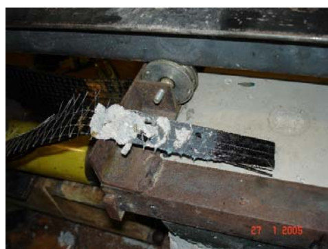
Figura 4.6 – Ruptura por arrancamento parcial do substrato de concreto do corpo-de-prova L50-R35-2; detalhe do arrancamento.
