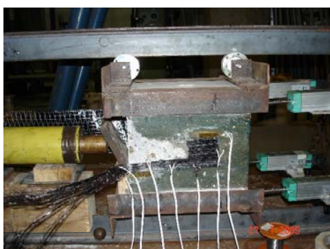
Figura 4.6 – Ruptura por arrancamento parcial do substrato de concreto do corpo-de-prova L50-R35-2; detalhe do arrancamento.
