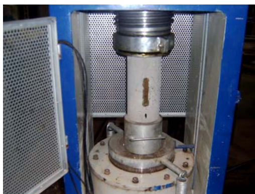
Figura 3.7 – Sistema de aplicação das cargas e corpo-de-prova após o ensaio.
