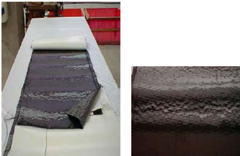
Figura 3.8 – Tecido de fibra de carbono com destaque para o sentido das fibras.
