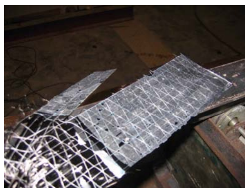
Figura 4.11 – Ruptura por descolamento do tecido com arrancamento do concreto no início da ancoragem do corpo-de-prova L100-R45; detalhe do descolamento com rompimento do tecido.
