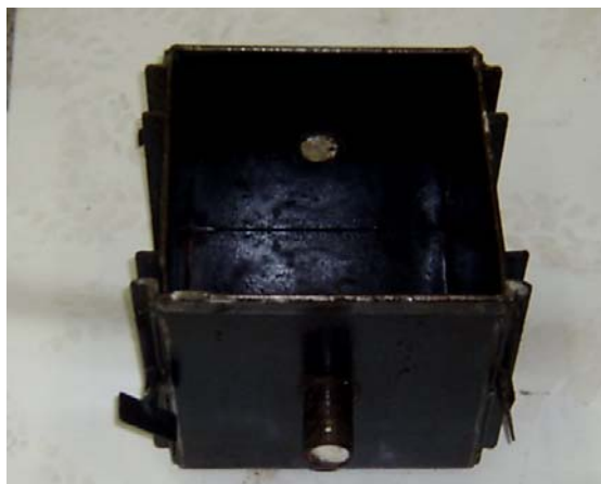
Figura 3.16 – Formas de aço para a confecção dos corpos-de-prova de concreto.
