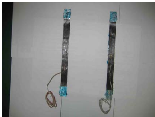
Figura 3.12 – Corpos-de-prova de tecidos de fibra de carbono revestidos com resina epóxi.
