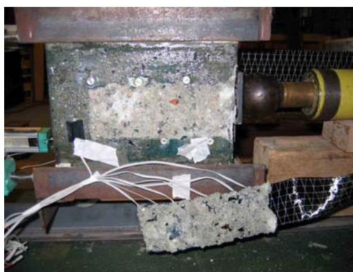
Figura 4.2 – Ruptura por arrancamento do substrato de concreto do corpo-de-prova L50-R25-1/piloto.
