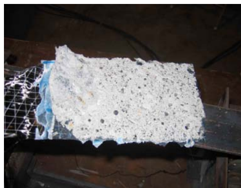
Figura 4.9 – Ruptura por arrancamento do substrato de concreto do corpo-de-prova L100-R25.
