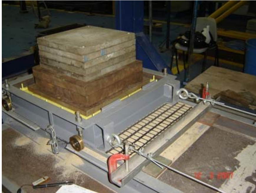
Figura 170 - Aplicação de tensão normal em um ensaio de interface solo-geogrelha ( \sigma_c=8,4\text{kPa} ).
