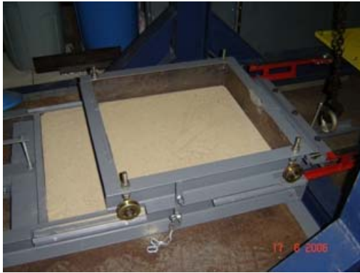
(a) Colocação da caixa superior.
