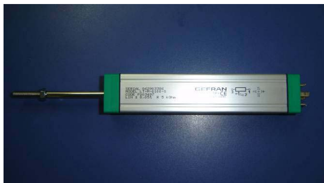
Figura 110 - Medidor de deslocamento horizontal marca Gefran.
