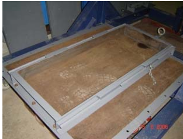
(a) Caixa inferior limpa e pronta para receber o solo.
