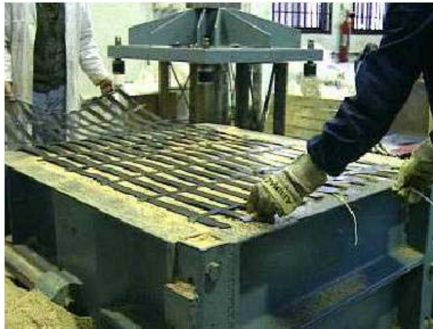
Figura 18 - Preparação de um ensaio de cisalhamento direto para uma interface solo-geotelha (Sieira, 2003).
