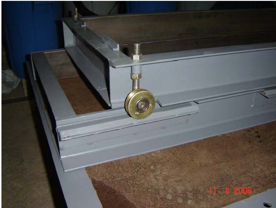
Figura 82 - Novo sistema trilho roldana.
