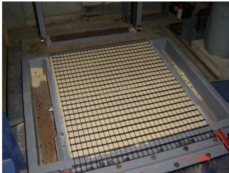
Figura 155 - Amostra de geogrelha na caixa média quadrada (dimensões 0,70 x 0,90m).
