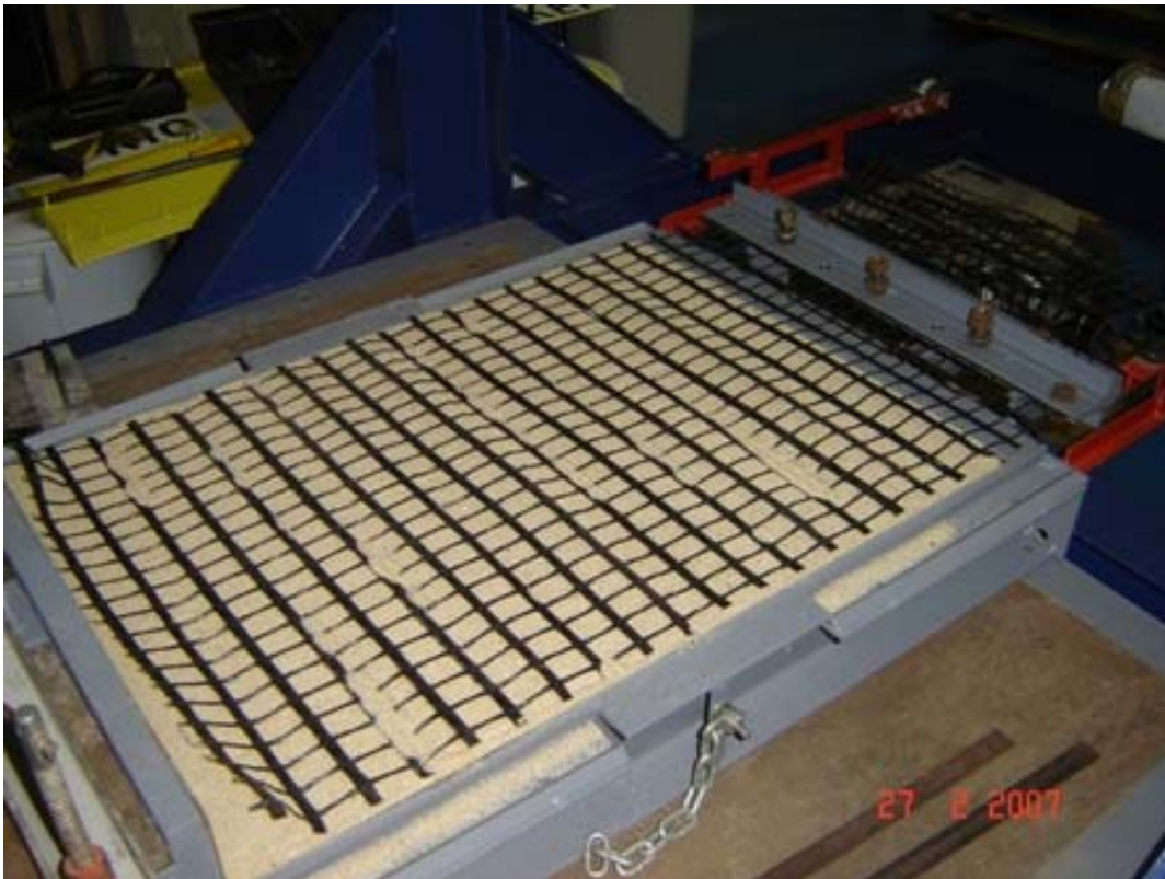
Figura 158 - Geogrelha na posição de ensaio.
