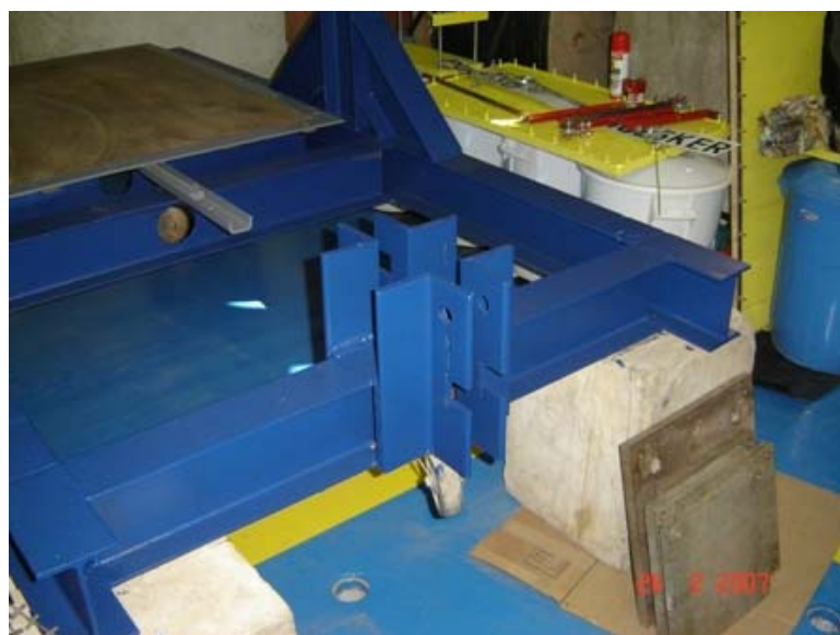
Figura 74 - Vista geral do ponto de apoio do sistema de aplicação de força cisalhante dos ensaios de cisalhamento, arrancamento e fluência.
