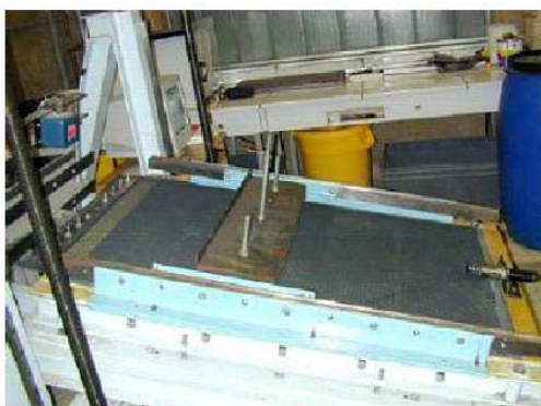
(b) Configuração para ensaios geossintético-geossintético.
