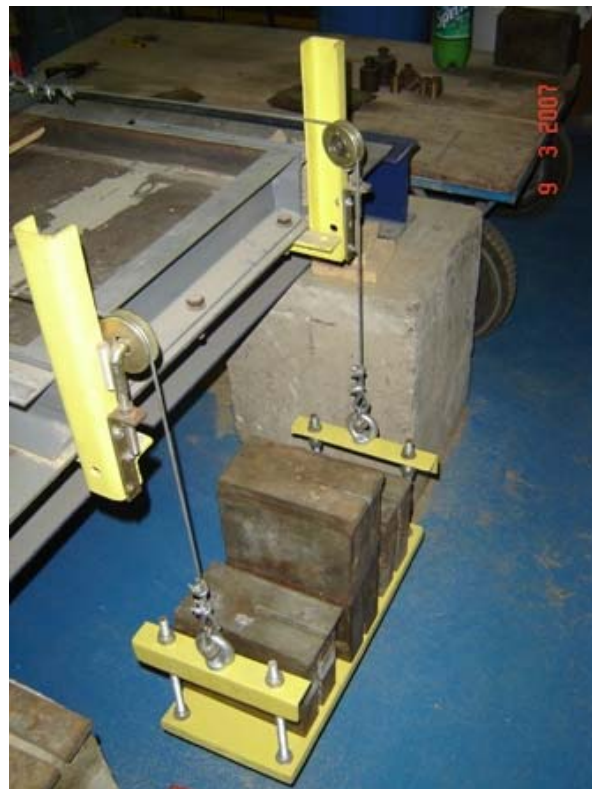
Figura 171 - Aplicação de tensão cisalhante.
