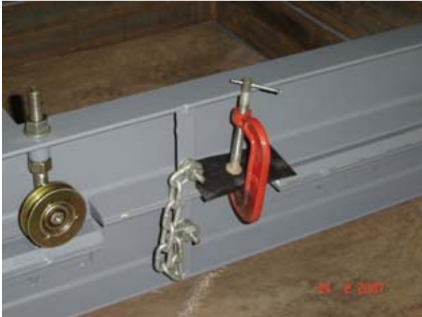
Figura 163 - Bloqueio da caixa superior com grampos tipo C..
