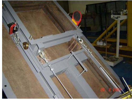
(c) Detalhe do travamento da caixa superior.
