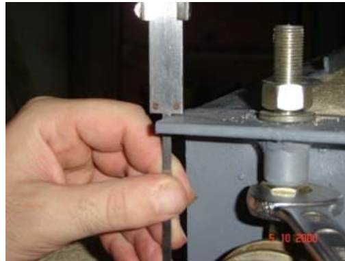
Figura 161 - Procedimento para espaçar a caixa de ensaio.
