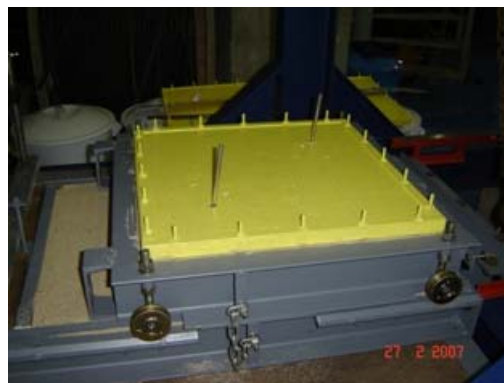
(f) Colocação da tampa de confinamento.
