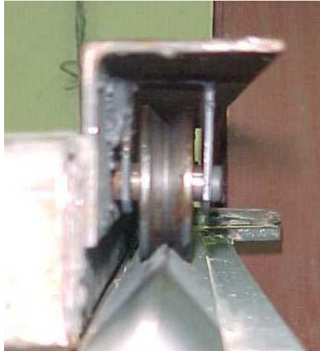
Figura 79 - Detalhe da roldana da caixa superior sobre o trilho da caixa inferior.
