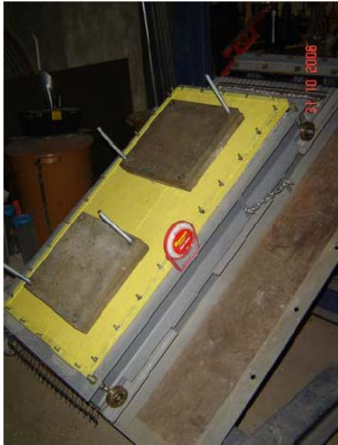
Figura 96 - Ensaio de rampa sob tensão confinante de 3,3kPa.
