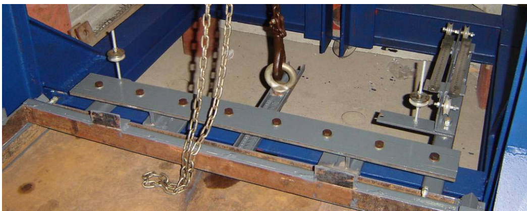
Figura 80 - Garra do conjunto 1 de caixas - Versão original.
