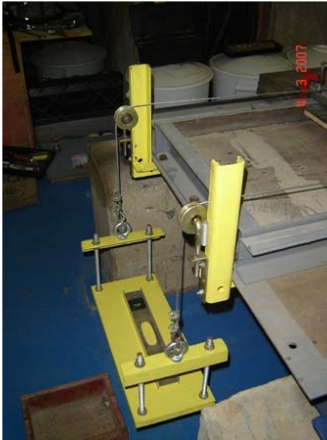
Figura 166 - Instalação dos suportes das roldanas e da plataforma.
