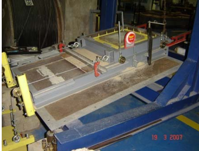
Figura 173 - Inclinação da plataforma para ensaio de cisalhamento direto inclinado. Observa-se o grampo tipo C impedindo o movimento da caixa superior.
