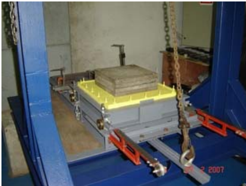
Figura 160 - Colocação das placas de confinamento.
