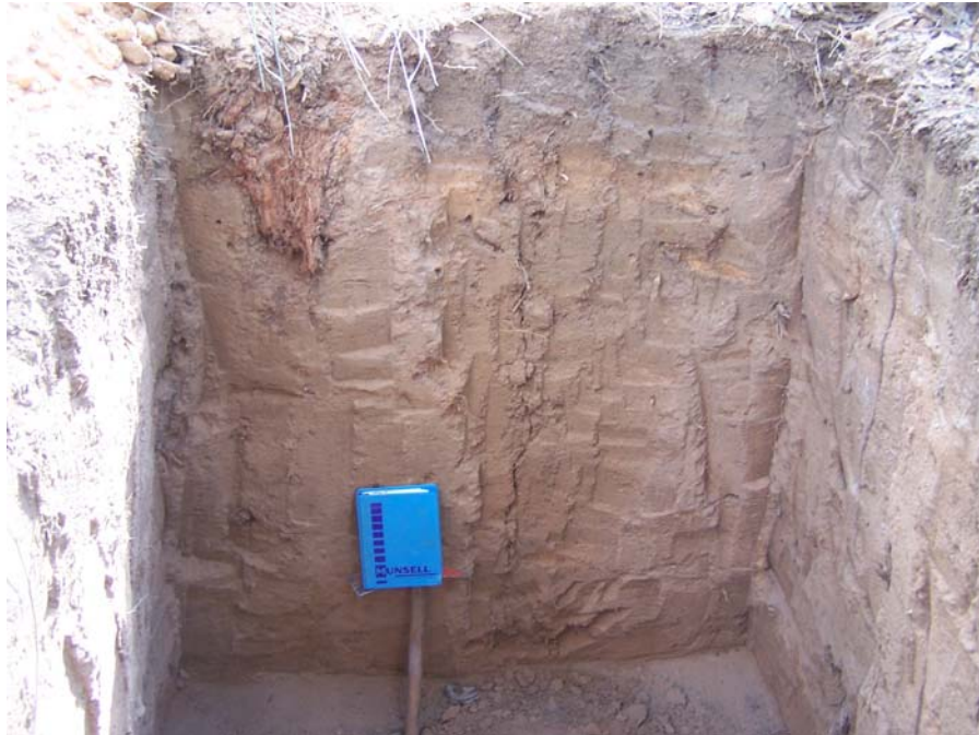
Figura 7. Perfil do Latossolo Amarelo, A moderado, textura muito argilosa, relevo suave ondulado - P19
