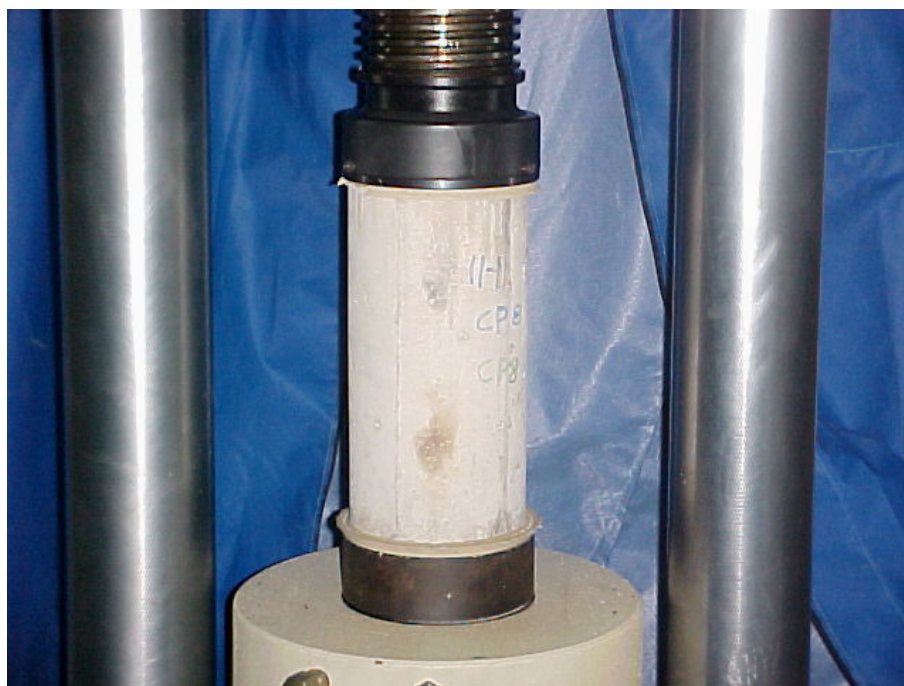
Figura 3.3 - Teste de compressão no corpo de prova de concreto
