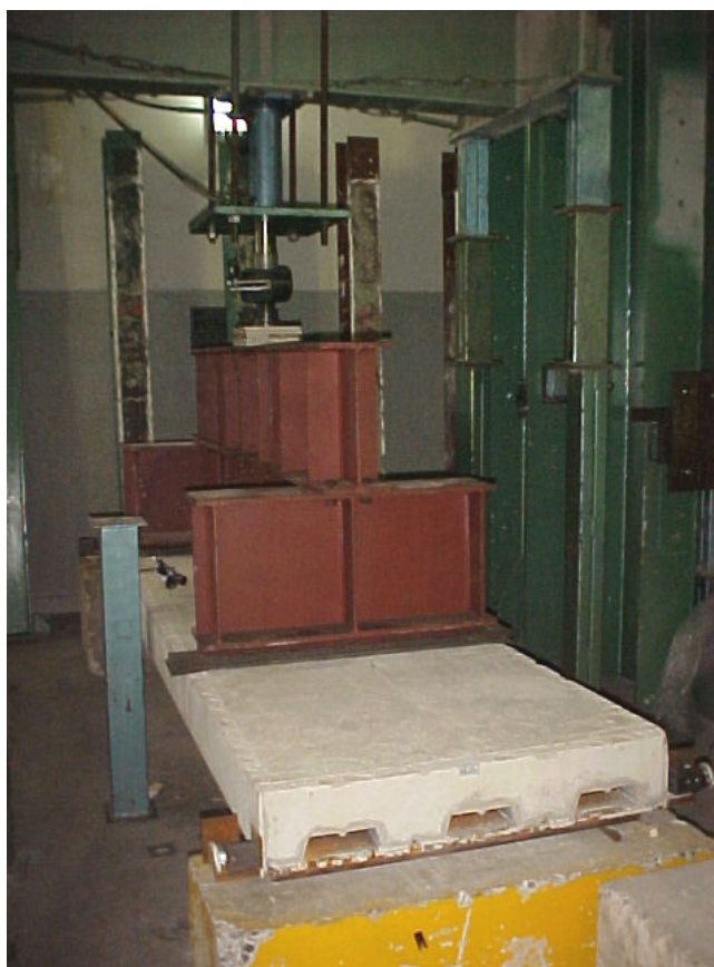
Figura C.3 - Pórtico para aplicação de carga na laje mista
