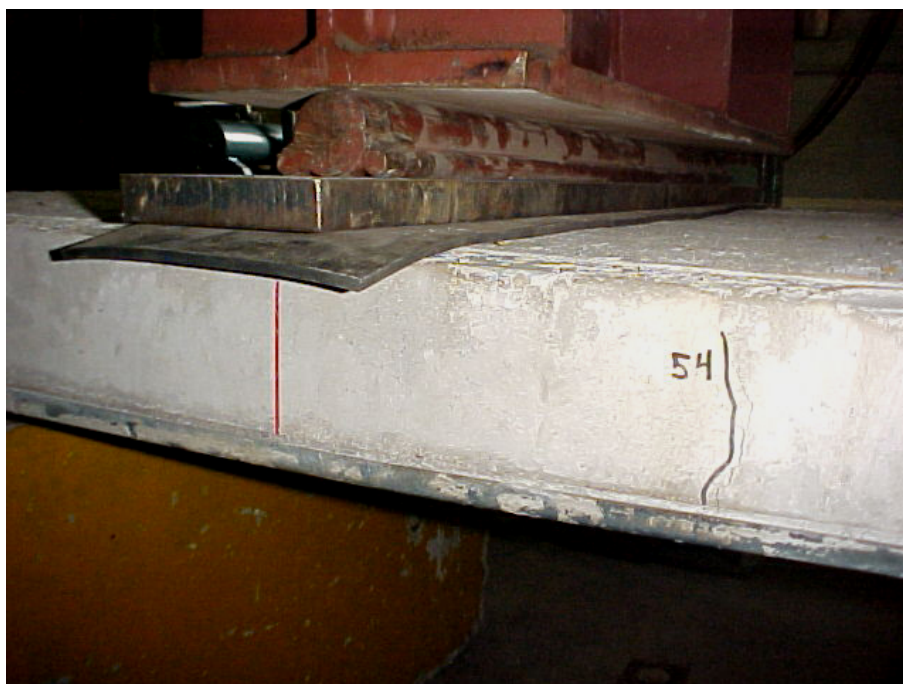
Figura 5.1 - Perfil das fissuras nos protótipos
