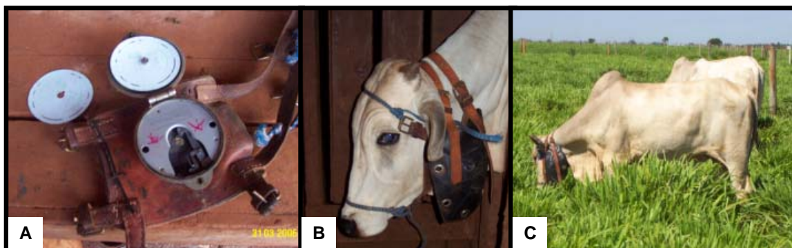
Figura 4 - (A) “Vibracorder”, (B) Posicionamento do aparelho no animal, (C) Monitoramento do tempo de pastejo, vista do animal com o aparelho.
