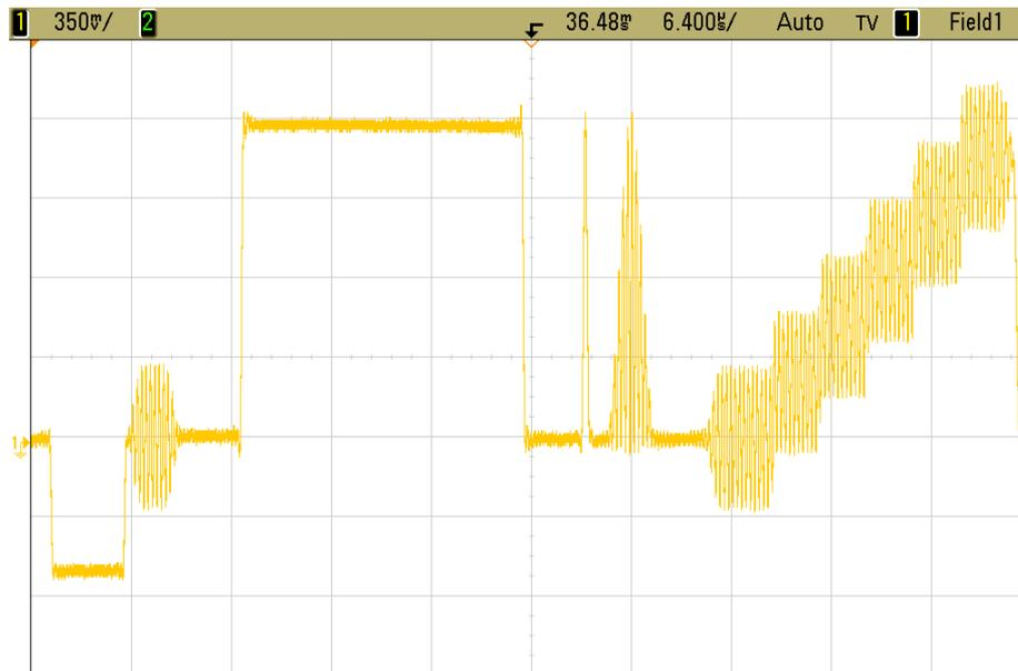
**Figura 4.14:** Medida de um sinal NTC7 composto com um osciloscópio. Deverá ser digitalizado para possibilitar o processamento digital.
