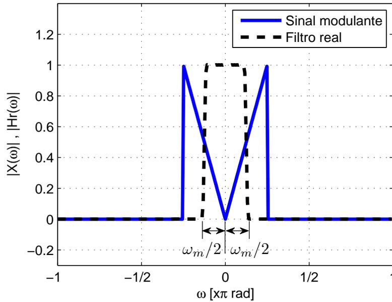
**Figura 3.2:** Resposta em frequência do filtro passa-baixa ideal com coeficientes puramente reais. Sua função de transferência foi sobreposta ao sinal modulante no domínio da frequência para salientar a relação entre a frequência de corte e a largura de faixa do sinal.
