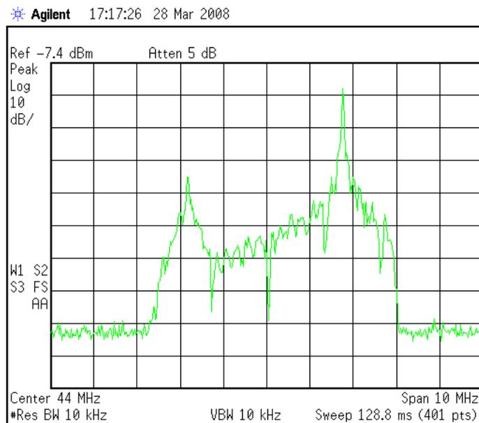
Figura 4.16: Sinal de vídeo composto modulado com banda lateral vestigial, no padrão M/N. Medida extraída de um modulador analógico implementado digitalmente através do método de filtragem complexa.
