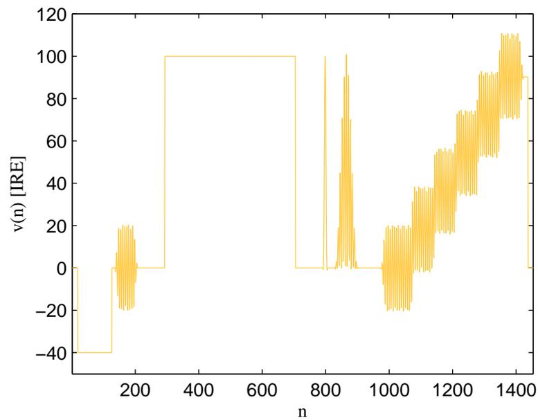
**Figura 4.13:** Sinal de vídeo composto NTC7. Sinal modulante de teste para o sistema de TV analógica.
