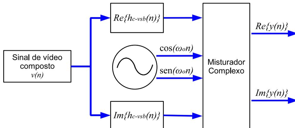
**Figura 4.12:** Diagrama em blocos de um modulador de vídeo composto. Esta é uma aplicação de DSP para sinais analógicos.
