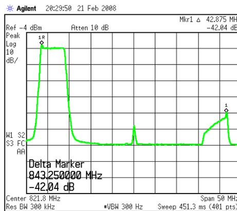
**Figura 4.28:** Resultado da mistura com rejeição de frequência imagem. O erro de amplitude foi compensado, restando somente a influência do erro de fase, que limitou o valor relativo da rejeição em 42,04 dB.
