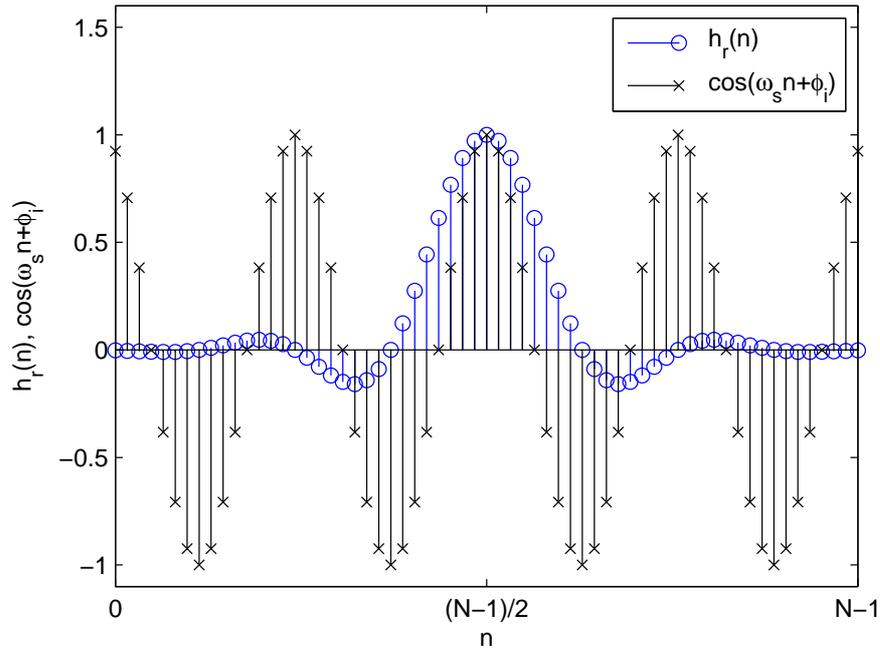
**Figura 3.4:** Sinais que compõem a parte real da multiplicação de (3.5). Uma vez empregado o valor ótimo de  $\phi_i$ , as funções  $\Re\{h_c(n)\}$  e  $\cos(\omega_s n + \phi_i)$  apresentam uma característica simétrica, em um mesmo instante  $(N-1)/2$ .
