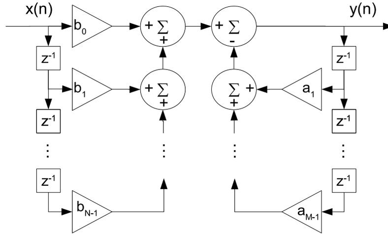
**Figura 3.9:** Diagrama em blocos de um filtro recursivo.
