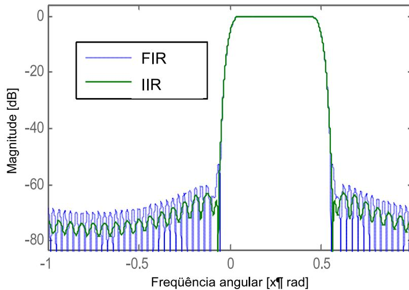
**Figura 3.13:** Resposta em frequência de um filtro FIR de 64<sup>a</sup> ordem sobreposta à do filtro IIR identificado de 32<sup>a</sup> ordem.
