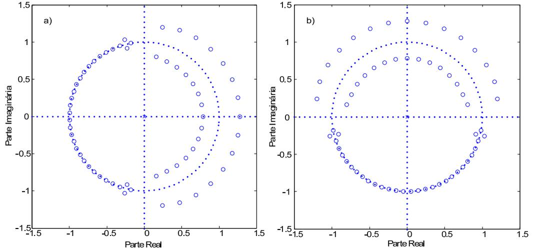
**Figura 3.3:** a) Diagrama de zeros e pólos de um filtro passa-baixa de meia banda de coeficientes reais. b) Diagrama de zeros e pólos de filtro de meia banda modulado por um tom complexo produzindo um filtro analítico de coeficientes complexos.
