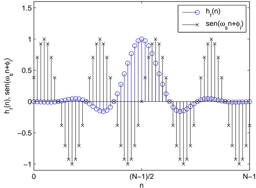
**Figura 3.5:** Sinais que compõem a parte imaginária da multiplicação em (3.5). Uma vez empregado o valor ótimo de  $\phi_i$ , as funções  $\Im\{h_c(n)\}$  e  $\text{sen}(\omega_s n + \phi_i)$  apresentam uma característica simetria e anti-simétrica, respectivamente, em um mesmo instante  $(N - 1)/2$ .
