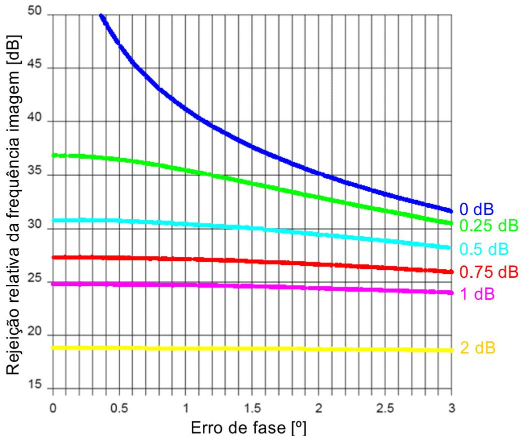
**Figura 4.26:** Rejeição da imagem em função das relações de amplitude e fase.
