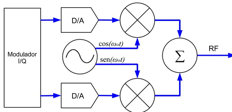
Figura 4.24: Misturador de rejeição de frequência imagem.
