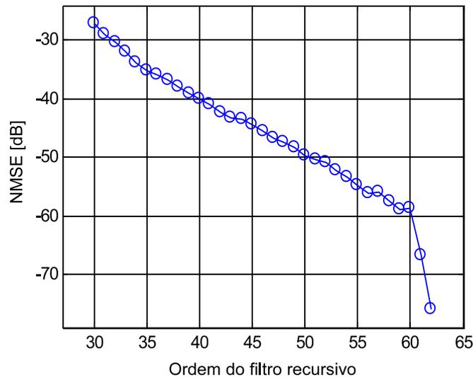
**Figura 3.11:** Diminuição do NMSE com o aumento da ordem do filtro recursivo. O filtro original é de 64<sup>a</sup> ordem.
