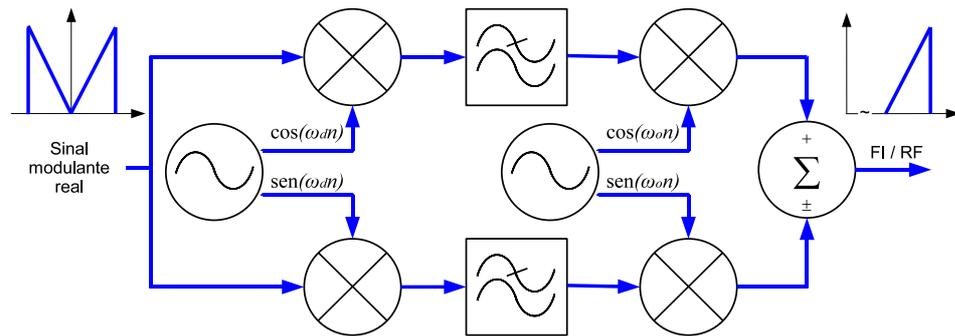
**Figura 2.5:** Diagrama em blocos do modulador de Weaver.
