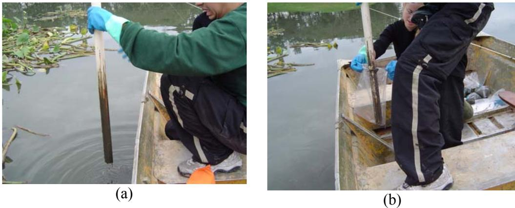
Figura 7.5. Retirada de amostras da bacia de retenção
