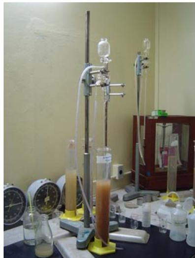
Figura 7.6. Visão geral da pipeta e da proveta
