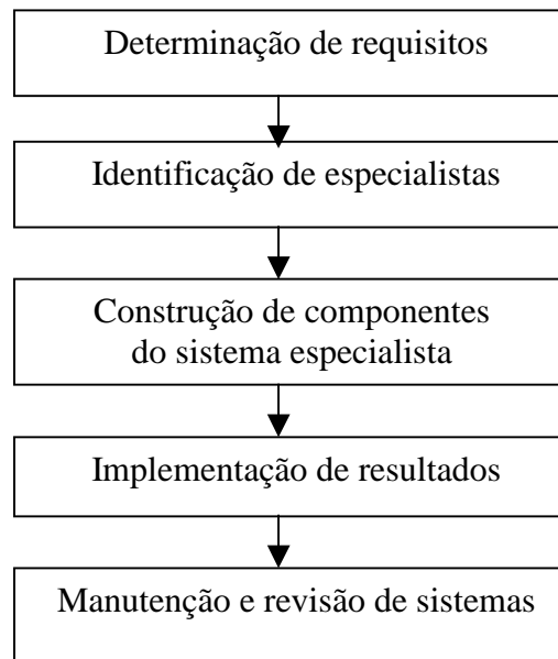
Figura 11 - Passos no processo de desenvolvimento de um sistema especialista
