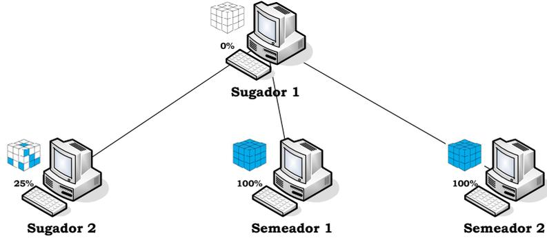
Figura 4.1: Exemplo de configuração de conexões para um nó.
