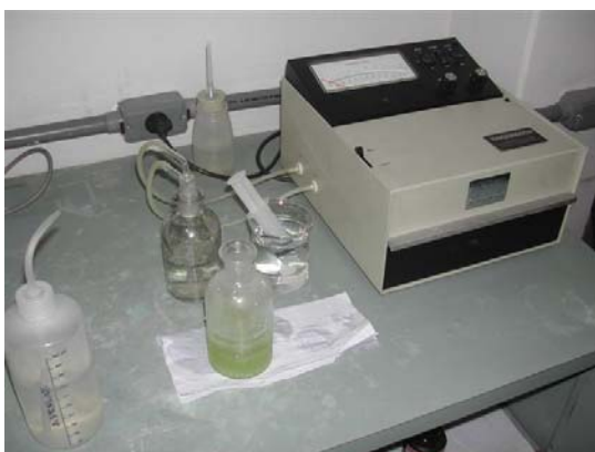
Figura 7. Equipamento Bacharach Coleman, modelo MAS-50 B acompanhado do recipiente de vidro contendo uma amostra digerida e becker com solução redutora.
