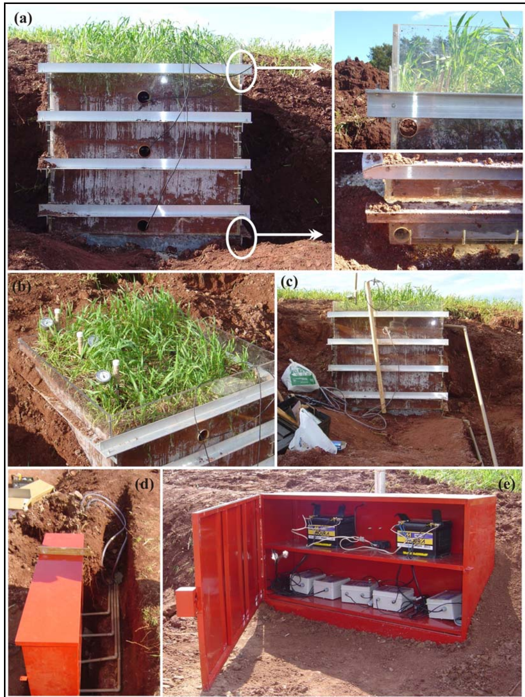
Figura 3.9. Instalação dos equipamentos de medição e de armazenamento de dados no lisímetro
