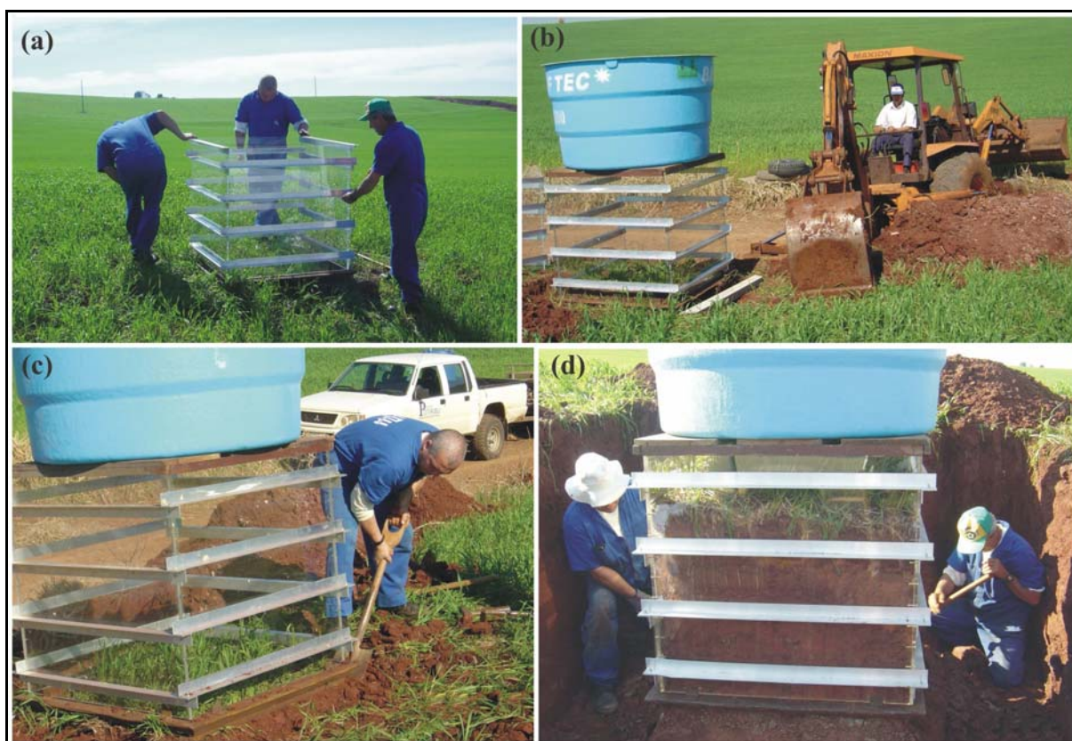
Figura 3.7. Coleta da amostra não deformada no campo
