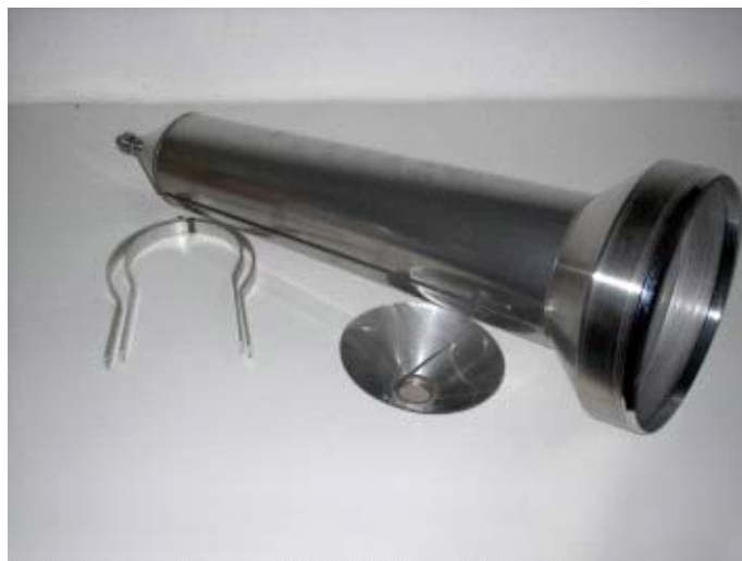
Figura 2.2. Pluviômetro tipo Ville de Paris
