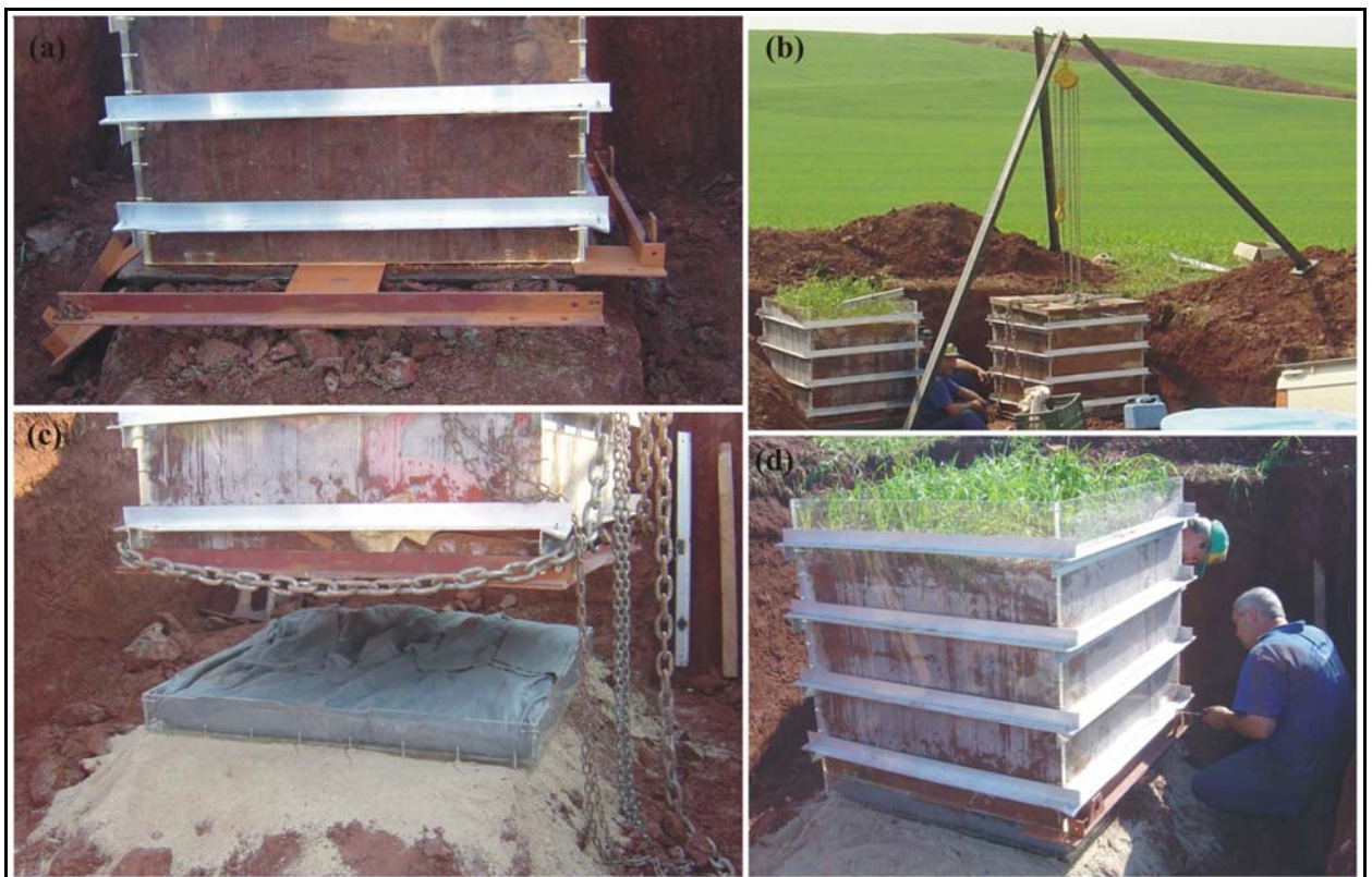
Figura 3.8. Montagem do lisímetro
