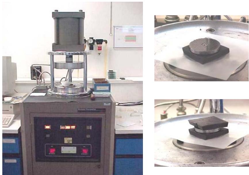
Figura 8 – Viscosímetro Mooney e montagem dos corpos de prova para análise
