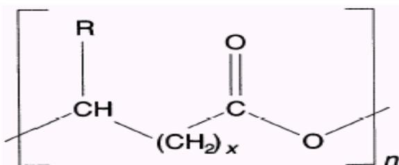
**FIGURA 3.** Estrutura geral dos polihidroxicanoatos
