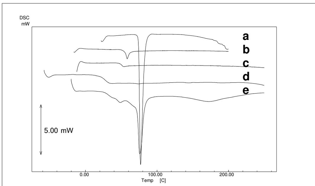
**FIGURA 10.** Curvas de DSC obtidas a partir do (a) IBF, (b) PLAGA, (c) microsferas de PLAGA brancas, (d) microsferas de IBF:PLAGA (1:4), (e) microsferas de IBF: PLAGA (1:2).
