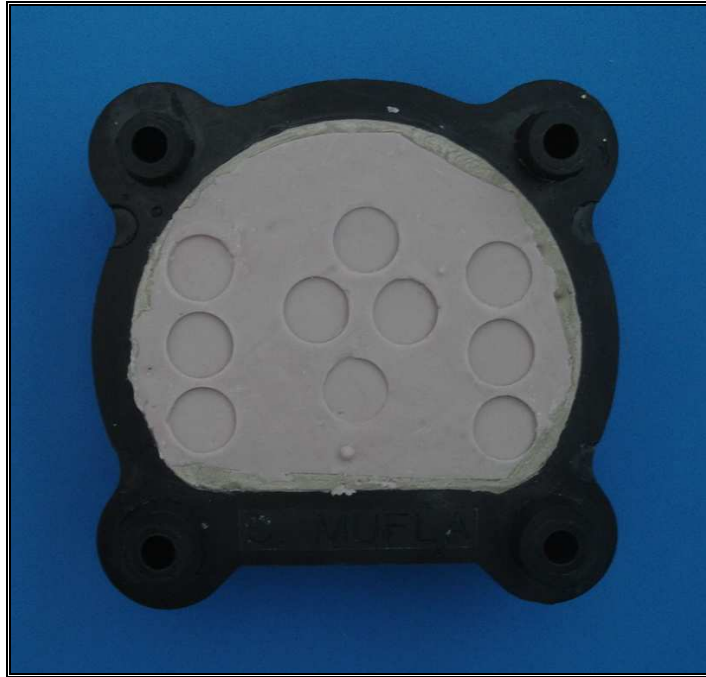
FIGURA 7 - Moldes em silicone laboratorial para preenchimento com resinas acrílicas, em mufla para microondas
