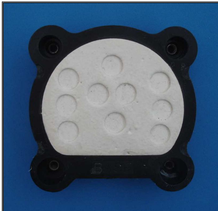
FIGURA 6 - Moldes em gesso ortodôntico para preenchimento com silicone Silastic, em mufla para microondas
