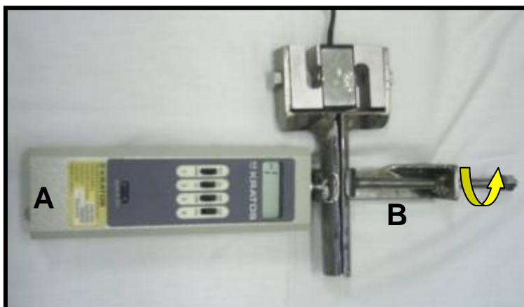
Figura 4 - Sistema de calibração das células de carga MM-50. A) Célula da carga digital M-50 e B) Suporte de fixação. A rotação do eixo (seta) permite a aplicação da força sobre a manopla.
