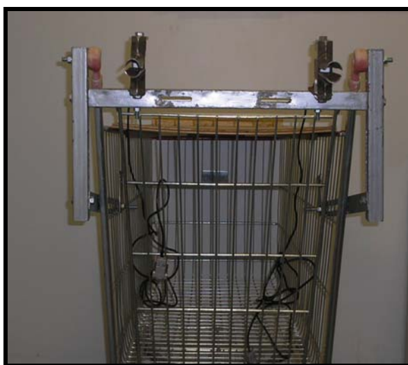
Figura 3 - Sistema acoplado ao veículo para fixação das células de carga e posicionamento das manoplas. Manoplas para preensão com punhos em desvio ulnar com antebraço em posição neutra.
