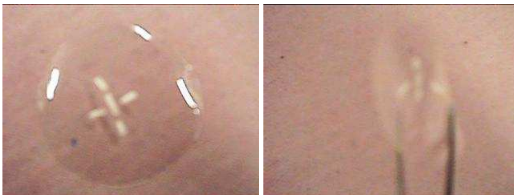
Figura 19 – Membrana de PVA com concentração de 30% em peso com sementes cilíndricas de Samário. Esquerda em repouso e Direita flexionada.
