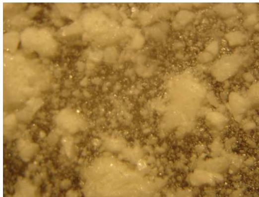
Figura 16 – Membrana de CMC com pó de semente de Samário, ampliação de 40X.
