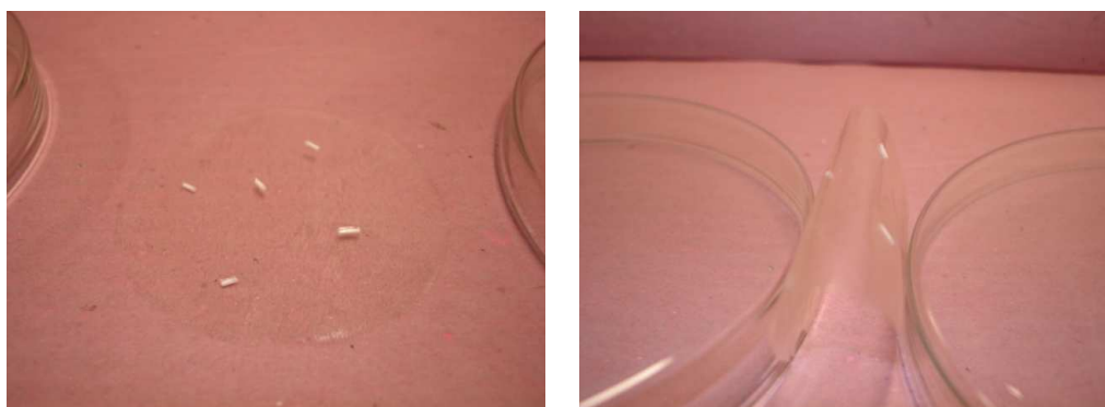
Figura 12 – Membrana de CMC, com concentração de 20% em peso com sementes cilíndricas de Samário. Esquerda em repouso e Direita flexionada.
