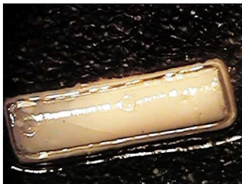
Figura 17 – Membrana de CMC obtida com uso de câmara de vácuo. Superfície de contato com a semente, ampliação de 40X.
