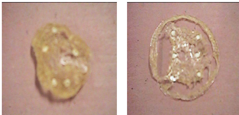
Figura 11 – Membranas com concentração de 30% de CMC em peso. Esquerda com arranjo circular de sementes e Direita com sementes arranjadas em 2 linhas.
