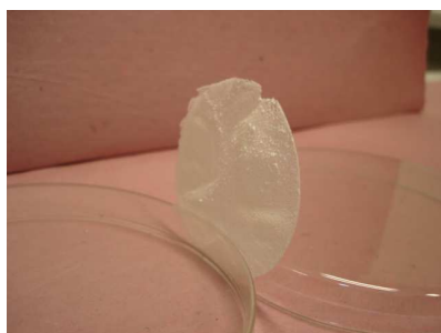
Figura 14 – Membrana de CMC, com concentração de 20% em peso, com pó de semente de Samário. Esquerda em repouso e Direita flexionada.
