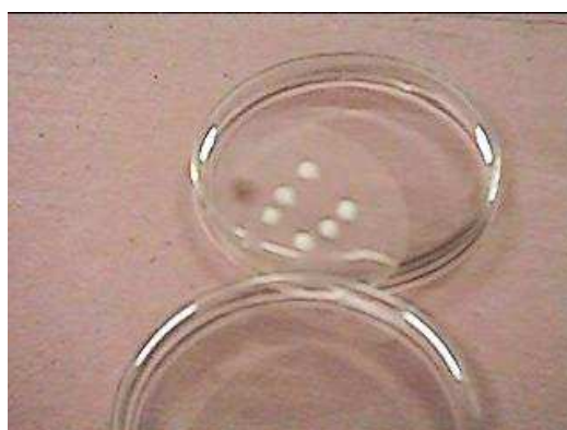
Figura 20 – Membrana de PVA com concentração de 30% em peso com sementes de Samário em forma de disco.
