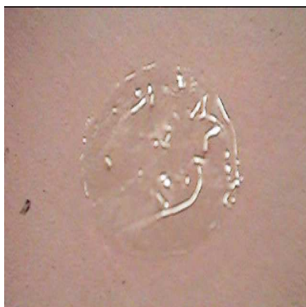
Figura 10 – Membrana com concentração de CMC de 10% em peso.
