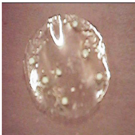
Figura 13 – Membrana de CMC, com concentração de 20% em peso, com sementes de Samário em forma de disco.
