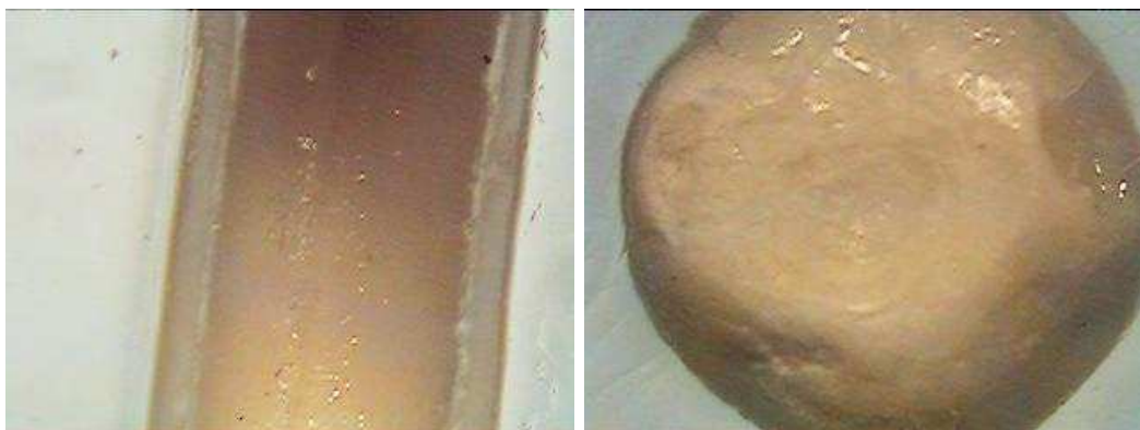
Figura 21 – Detalhe estereoscópico de sementes de Samário incorporadas em membrana de PVA com concentração de 30% ampliação de 80X. Esquerda semente cilíndrica e direita semente em forma de disco.
