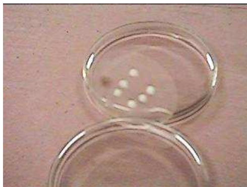
Figura 6 – Membrana de PVA submetida ao teste de degradação.
