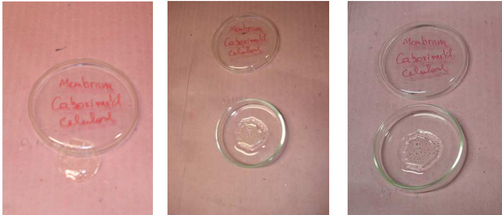
Figura 24 – Membrana de CMC, com concentração de 20% em peso, sob teste de degradação antes da imersão e após 15 e 30 minutos.
