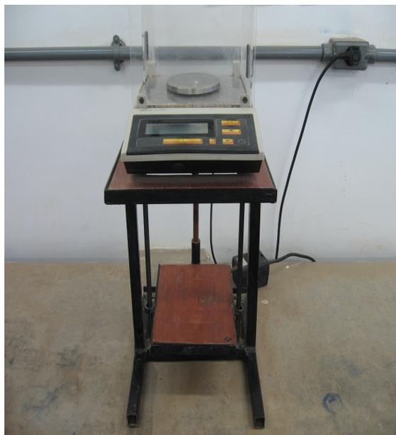
**Figura A13:** Balança hidrostática
