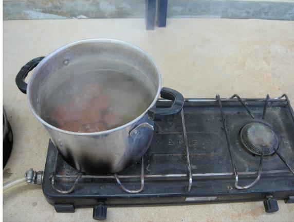
**Figura A12:** Corpos-de-prova em fervura
