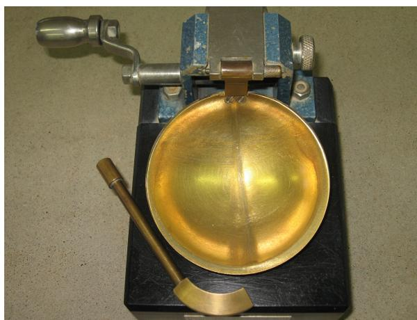
**Figura A8:** Aparelho de Casagrande e cinzel.
