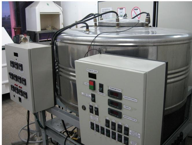
**Figura A15:** Ensaio de lixiviação em corpos-de-prova com dimensões reais.
