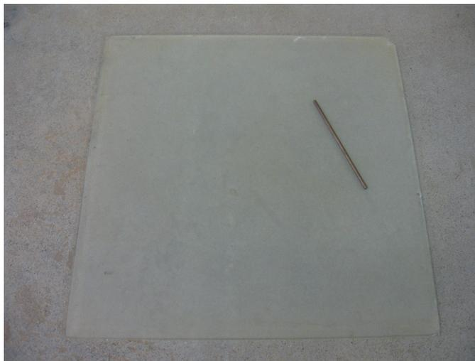
**Figura A10:** Placa de vidro e o gabarito cilíndrico com 3 mm de diâmetro e cerca de 100 mm de comprimento.
