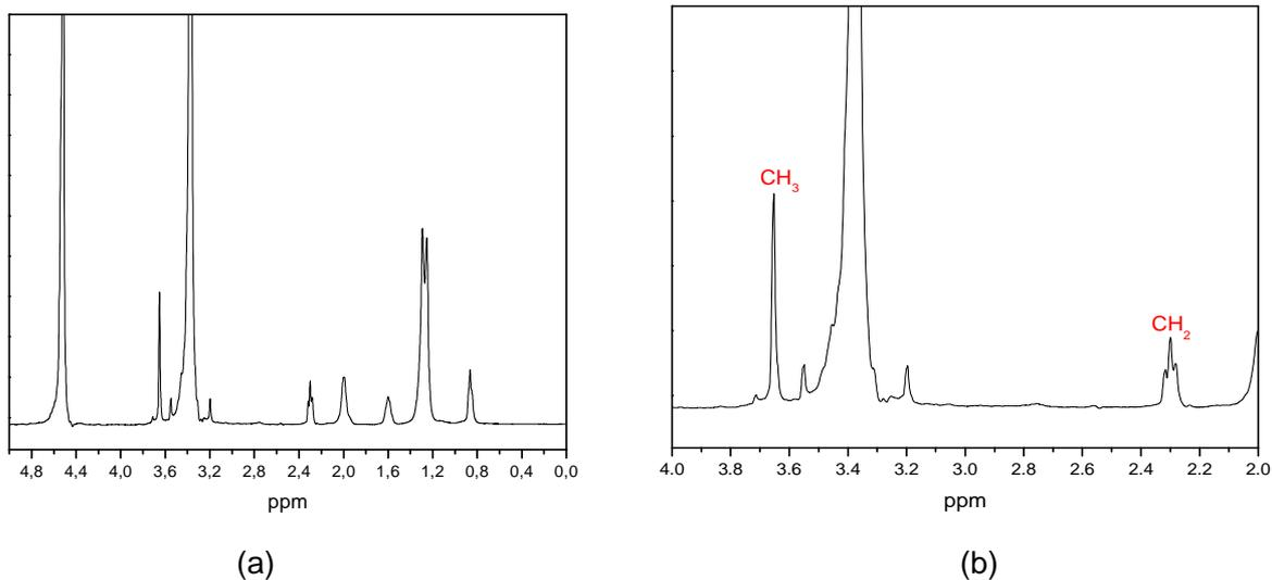
Figura 32- RMN-<sup>1</sup>H após a reação de 5 horas do catalisador NbSO<sub>4</sub> com ácido oléico e metanol ; a) espectro sem expansão e b) expandido na região de 2,0 ppm a 4,0 ppm indicando em 3,65 ppm o surgimento do simpleto correspondente a metila do éster formado.
