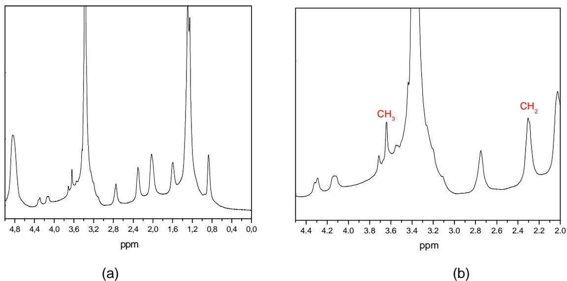
Figura 33- RMN-<sup>1</sup>H após a reação de 5 horas do catalisador NbSO<sub>4</sub> com óleo de soja e metanol ; a) espectro sem expansão e b) expandido na região de 2,0 ppm a 4,0 ppm indicando em 3,65 ppm o surgimento do simpleto correspondente a metila do éster formado.
