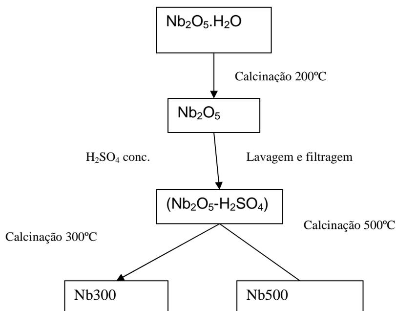
Fluxograma 3- Síntese do catalisador de nióbio sulfatado com  $\text{H}_2\text{SO}_4$  4,0 mol/L e calcinado à 300 °C e 500 °C.
