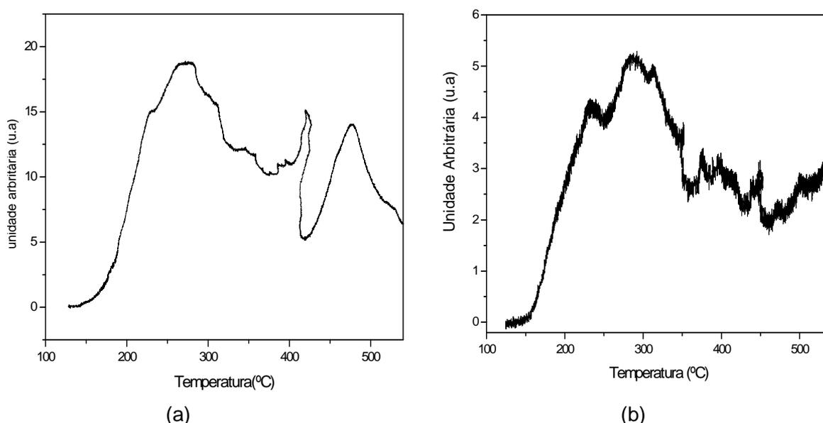
Figura 15- a) Perfil de dessorção do catalisador  $\text{Nb}_2\text{O}_5$  tratado com  $\text{H}_3\text{PO}_4$  1,5 mol/L sem calcinação e b) Perfil de dessorção do mesmo catalisador NbPO, mas calcinado à 300°C .
