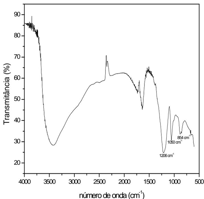
Figura 13- Espectro de infravermelho do catalisador NbSO<sub>4</sub>.
