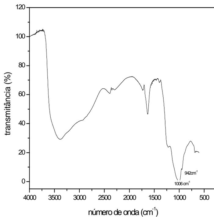
Figura 16- Espectro de infravermelho do catalisador NbPO.
