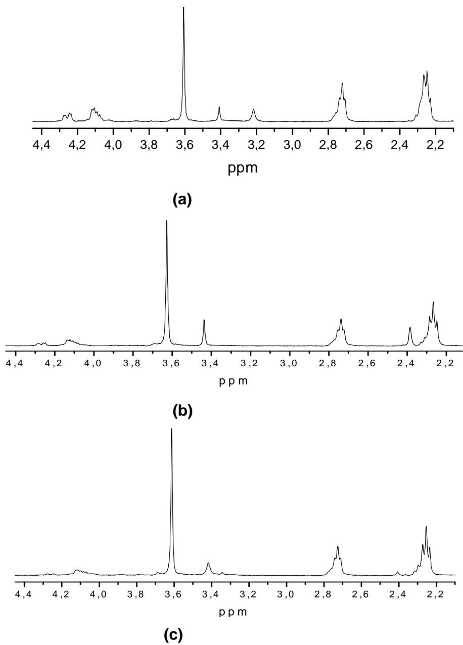
Figura 26- Espectros de biodiesel metílico catalisado por ácido p-tolueno sulfônico: a) 20 min, b) 40 min e c) 60 min, respectivamente.
