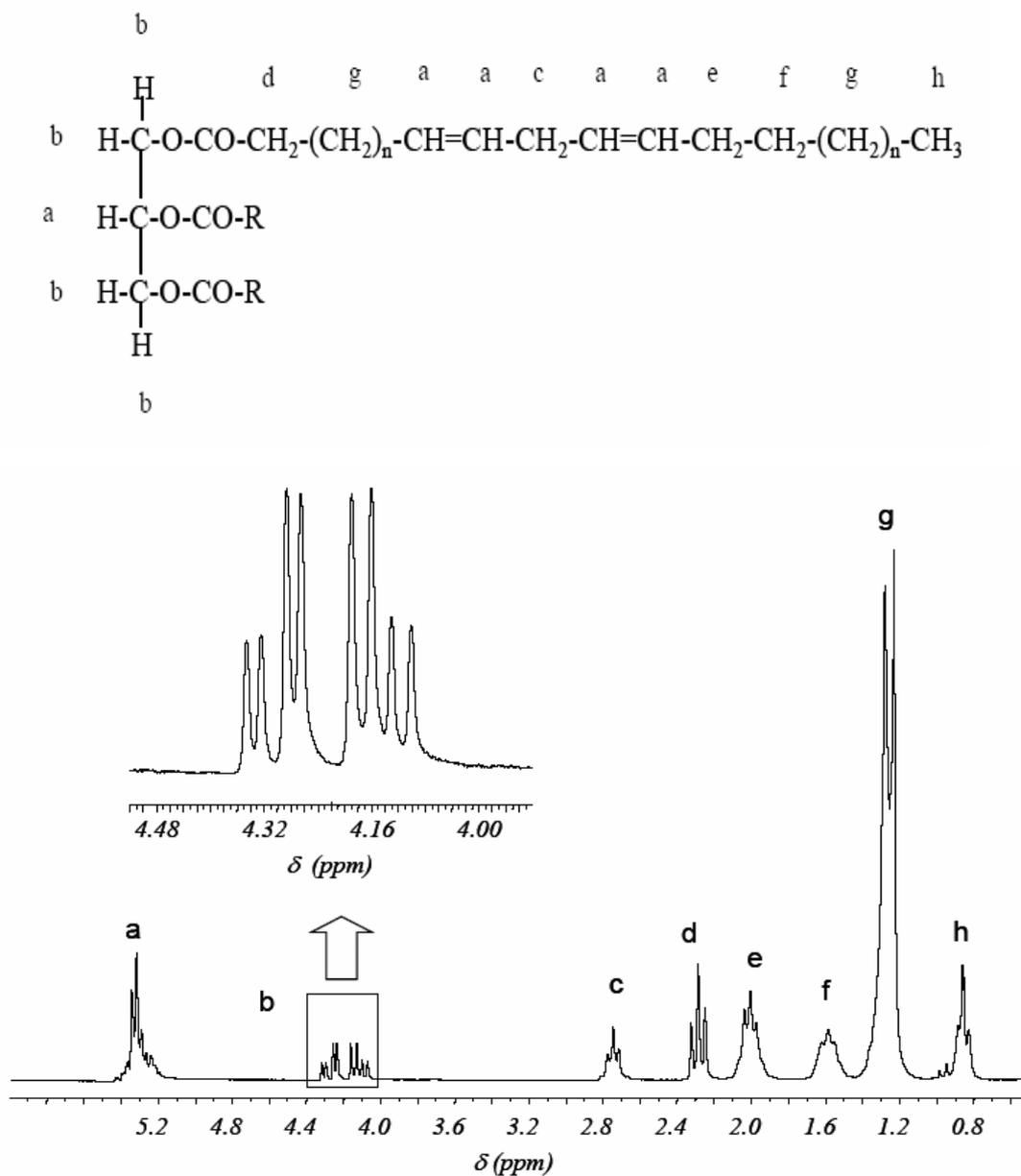
Figura 17- Espectro de RMN-<sup>1</sup>H de uma solução em clorofórmio deuterado do óleo de soja comercial usado nas reações de transesterificação. Em detalhe a ampliação dos sinais dos dois grupos metilênicos do fragmento glicerol da molécula de triglicerídeo.
