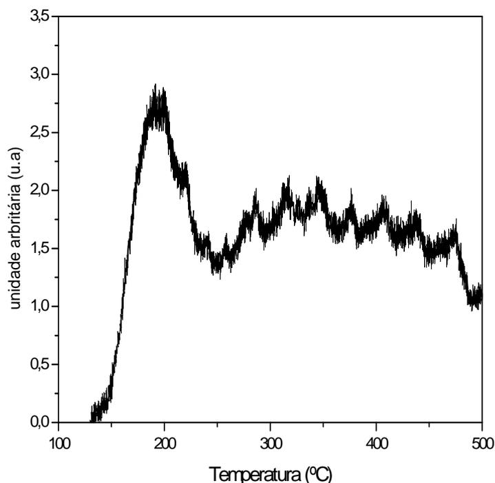
Figura 7- Perfil de dessorção de amônia para a amostra [H]Al/MCM-41.
