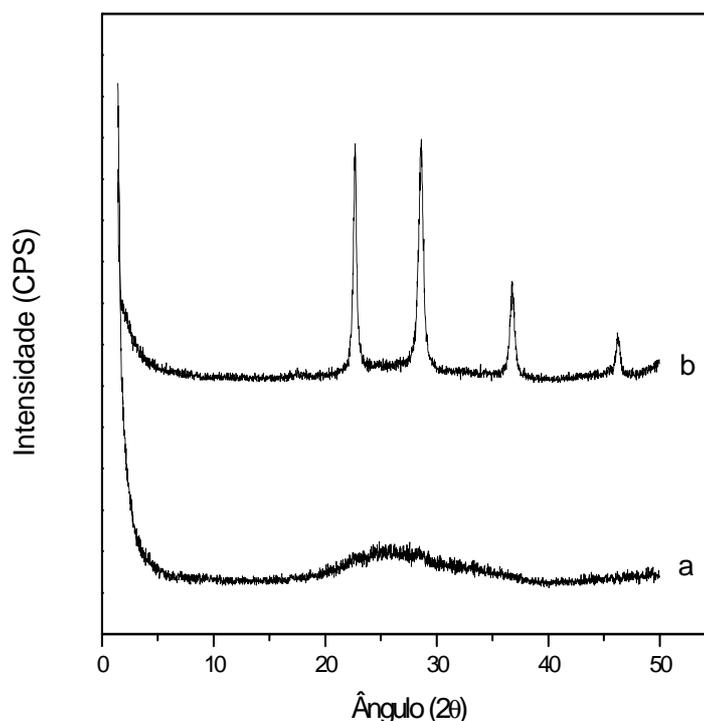
Figura 8- Cromatogramas dos catalisadores : a) Nb300 e b) Nb500.
