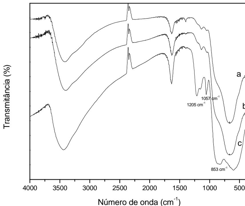
Figura 10- Espectro no infravermelho das amostras. a)  $\text{Nb}_2\text{O}_5 \cdot n\text{H}_2\text{O}$  : b) Nb300 e c) Nb500.
