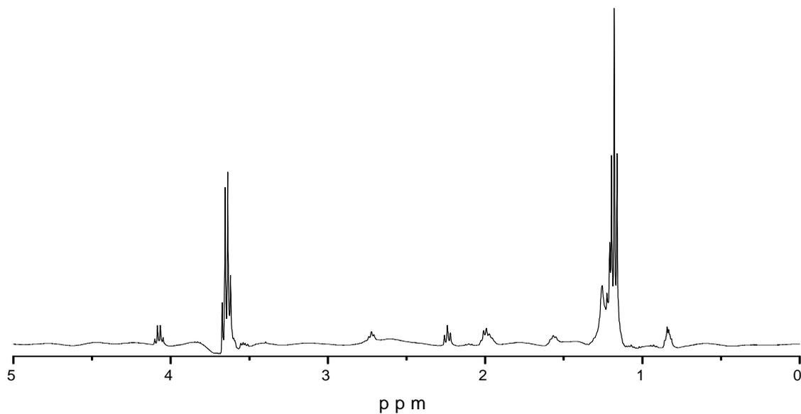
Figura 22 - Espectro de RMN-<sup>1</sup>H do biodiesel etílico da fase superior após 16 min de reação. Em destaque os quadrupletos que aparecem em 3,65 e 4,2 ppm devido aos grupos metilênicos do etanol em excesso e da etoxila do éster formado.
