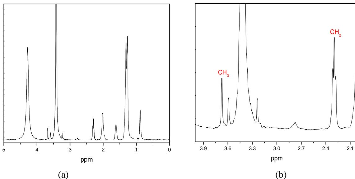
Figura 29- RMN-<sup>1</sup>H após a reação de 5 horas do catalisador [H]Al/MCM-41 com ácido oléico e metanol ; a) espectro sem expansão e b) expandido na região de 2,0 ppm a 4,0 ppm indicando em 3,65 ppm o surgimento do simpleto correspondente a metila do éster formado.
