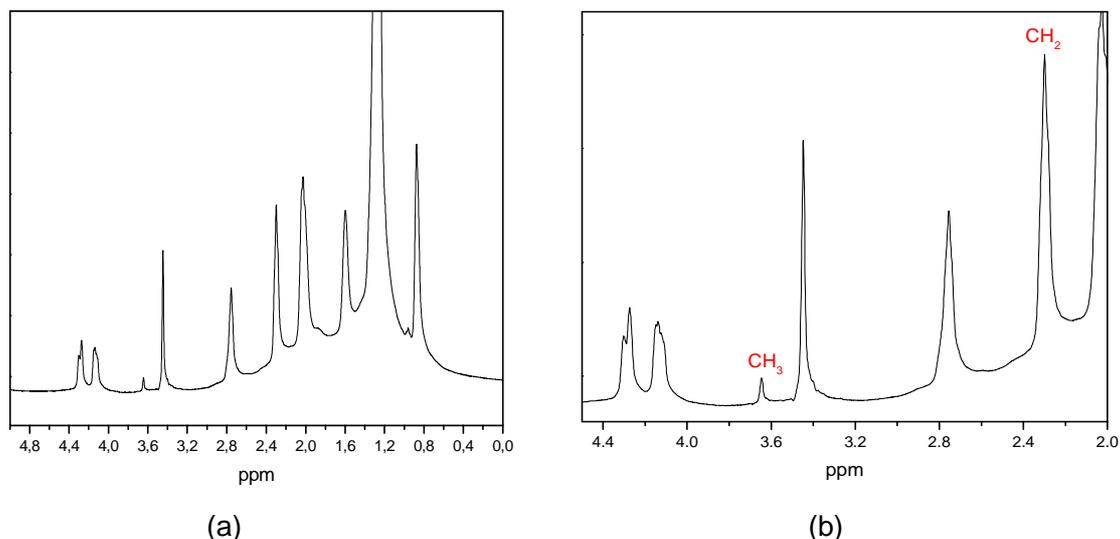
Figura 35- RMN-<sup>1</sup>H após a reação de 5 horas do catalisador NbPO com óleo de soja e metanol ; a) espectro sem expansão e b) expandido na região de 2,0 ppm a 4,0 ppm indicando em 3,65 ppm o surgimento do simpleto correspondente a metila do éster formado.
