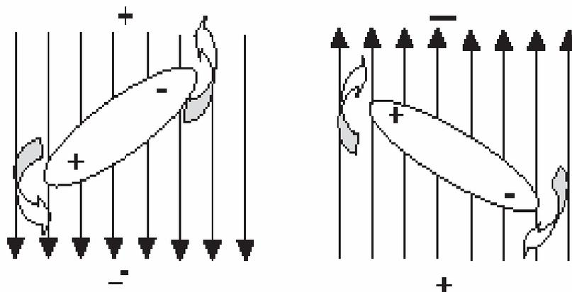
Figura 4- Efeito do alinhamento do dipolo em função do campo elétrico aplicado.
