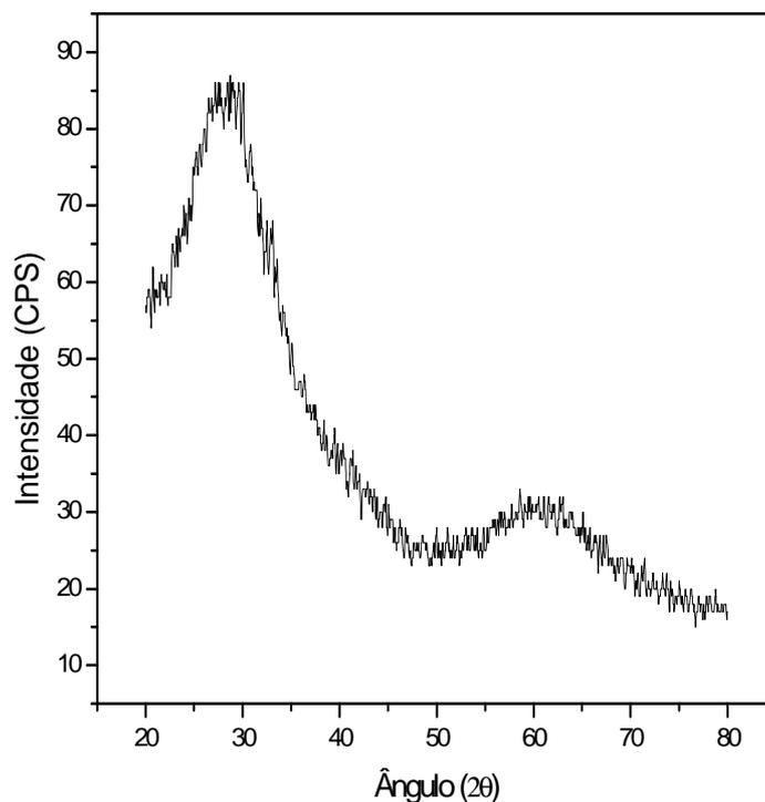
Figura 11- Difratograma do catalisador  $\text{NbSO}_4$ .
