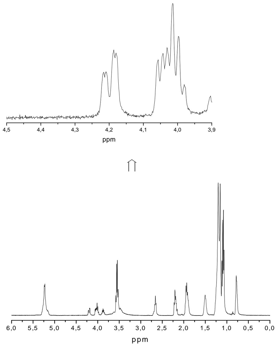
Figura 21: RMN- $^1\text{H}$  de uma mistura de biodiesel etílico com óleo de soja na proporção (1:1) em peso, destacando a sobreposição dos picos devido aos grupos metilênicos do fragmento glicerol da molécula do triglicerídeo e do grupo etoxila do éster formado (ver expansão acima).
