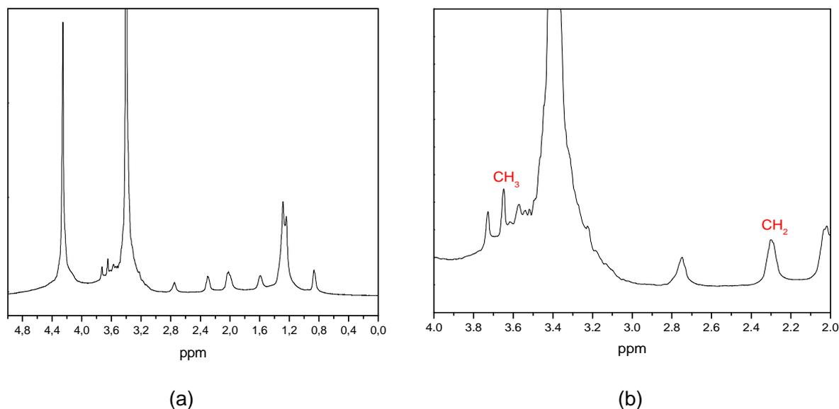
Figura 34- RMN-<sup>1</sup>H após a reação de 5 horas do NbPO com ácido oléico e metanol ; a) espectro sem expansão e b) expandido na região de 2,0 ppm a 4,0 ppm indicando em 3,65 ppm o surgimento do simpleto correspondente a metila do éster formado.
