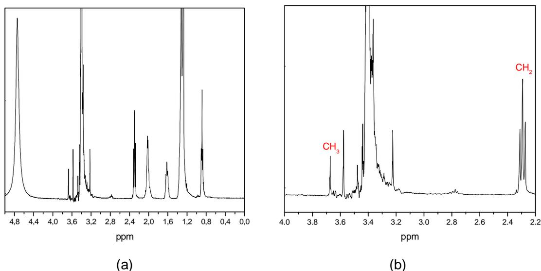
Figura 30- RMN-<sup>1</sup>H após a reação de 5 horas do catalisador Nb300 com ácido oléico e metanol ; a) espectro sem expansão e b) expandido na região de 2,0 ppm a 4,0 ppm indicando em 3,65 ppm o surgimento do simpleto correspondente a metila do éster formado.
