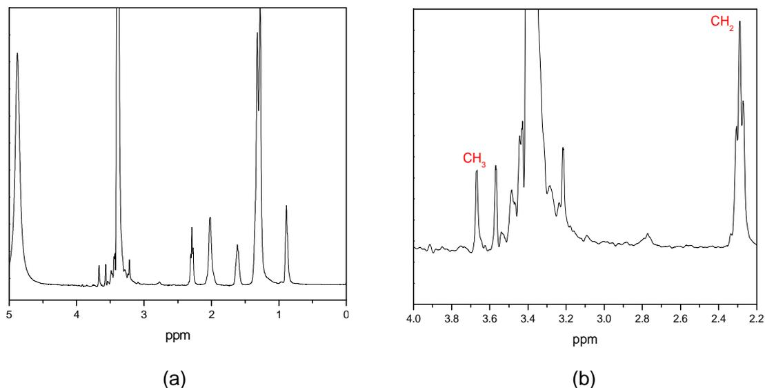
Figura 31- RMN-<sup>1</sup>H após a reação de 5 horas do catalisador Nb500 com ácido oléico e metanol ; a) espectro sem expansão e b) expandido na região de 2,0 ppm a 4,0 ppm indicando em 3,65 ppm o surgimento do simpleto correspondente a metila do éster formado.
