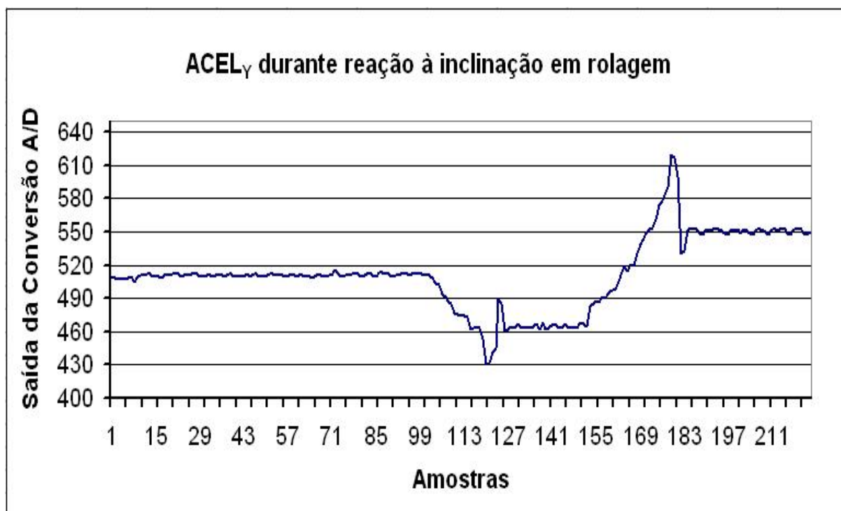
Figura 5.29 - Resposta do acelerômetro à inclinação forçada de rolagem do plano de locomoção.
