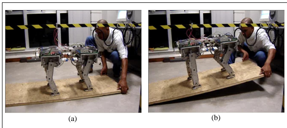
Figura 5.28 - Reflexo de compensação à inclinação sobre pernas traseiras, mergulho negativo.
