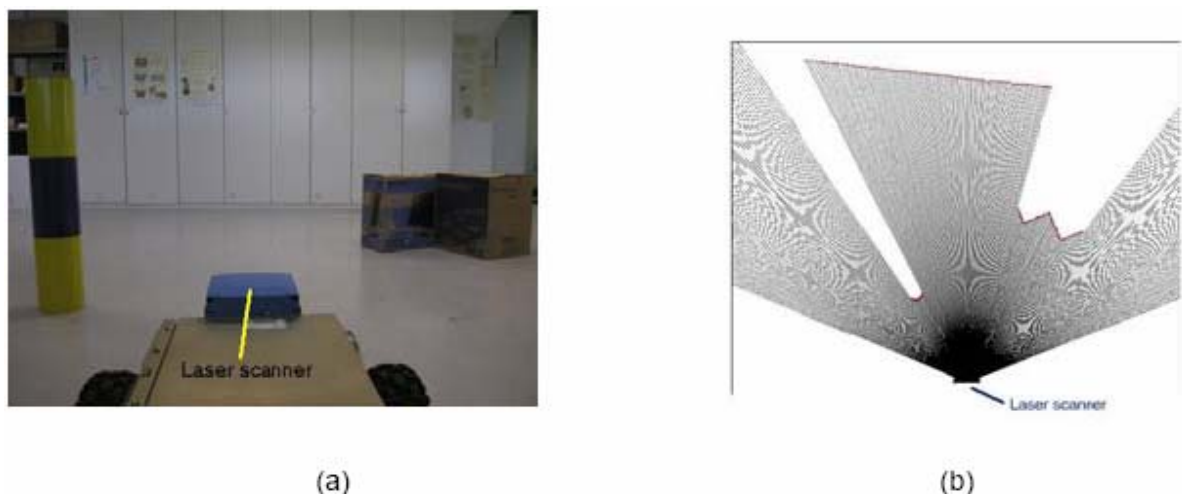
Fig. 2.2 - Reconhecimento do ambiente com o uso de sistemas de varredura laser .
