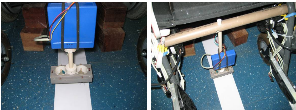
Fig. 4.9 - Conjunto de antenas dos sensores 1 e 2 (cinza), haste e estojo do circuito.
