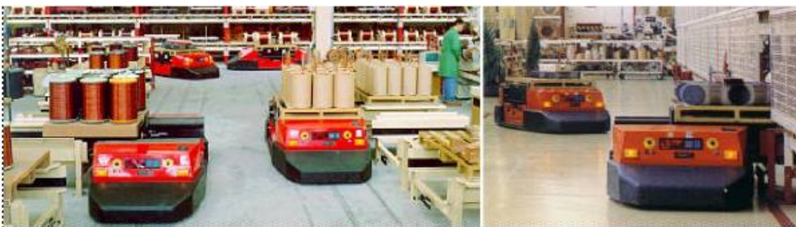
Fig. 2.1 - AGV atuando em uma fábrica de transformadores.
