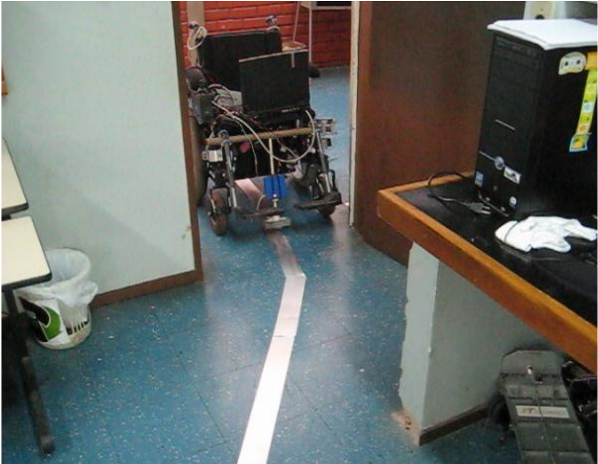
Fig. 7.7 - Trilha montada para testes finais em uma porta de 80 cm
