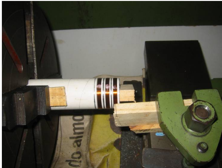
Fig. 4.8 - Construção dos elementos do sensor de indução.
