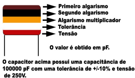
Figura 28 – Capacitor com o código das cores. Fonte: < http://pt.wikipedia.org/wiki/Capacitor >, acesso em 11 jan 2007
