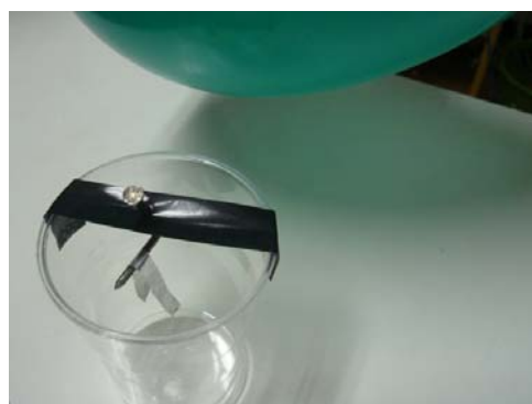
Fotografia 11 – Eletroscópio de folhas sofrendo indução.
