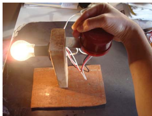
Fotografia 19 – Baixa luminosidade, iluminação pública ligada. Fonte: o autor (2006)
