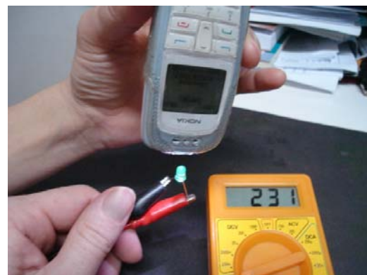
Fotografia 31 – LED conectado de forma correta.
