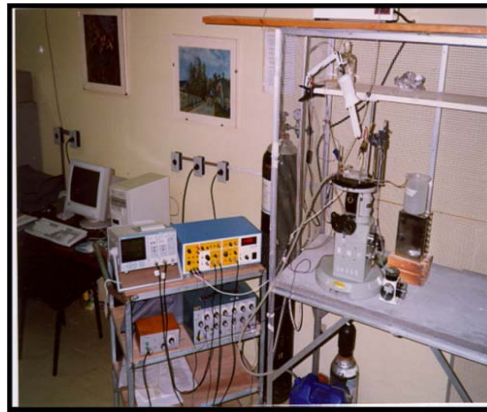
Figura 4.1 - Disposição da câmara de perfusão e do microeletrodo para o registro intracelular.
