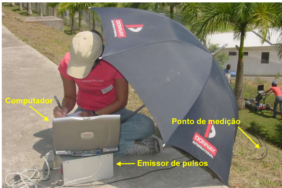
Figura 6.6 – Valor da constante dielétrica sendo medido com ao auxílio do TDR
