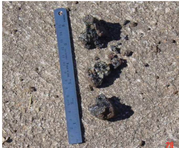
Figura 5.8 – Escória preenchida com óleo encontrada durante furo de sondagem
