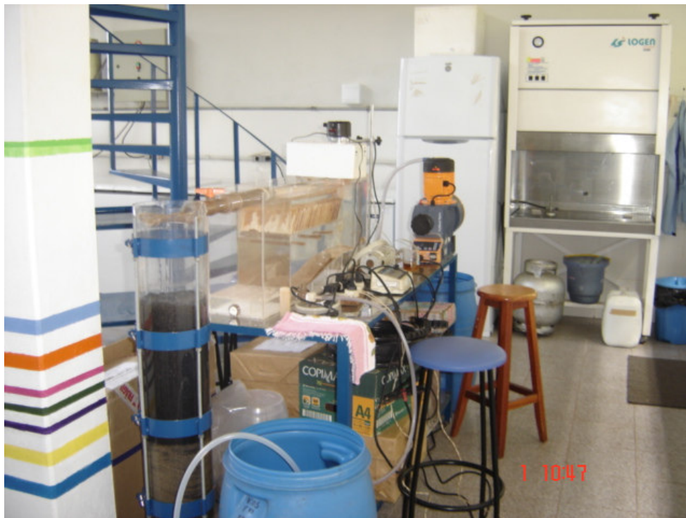
Figura 13 – ETA Piloto. Vista do filtro e reservatório de água filtrada
