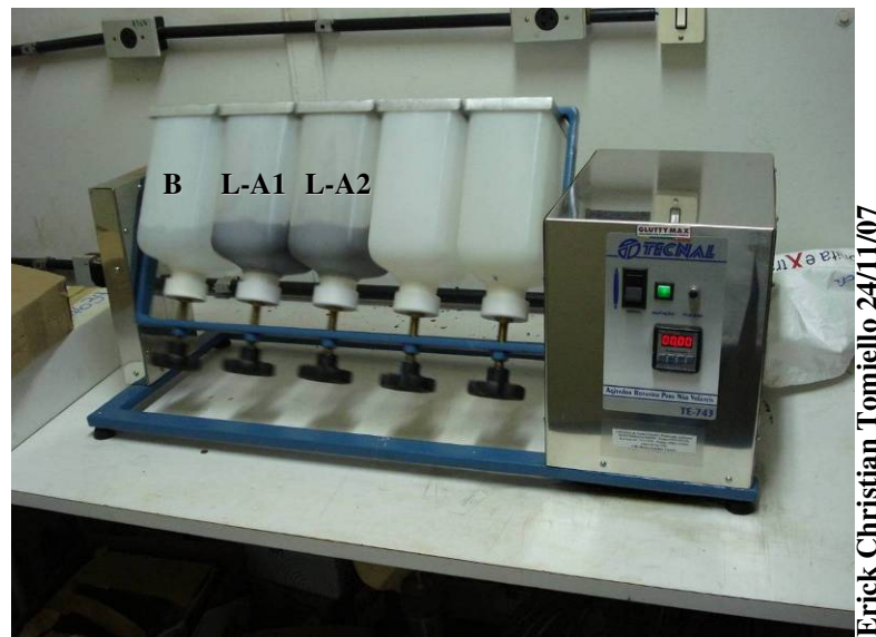
Figura 5.30 – Agitador rotatório de frascos utilizado no ensaio de lixiviação
