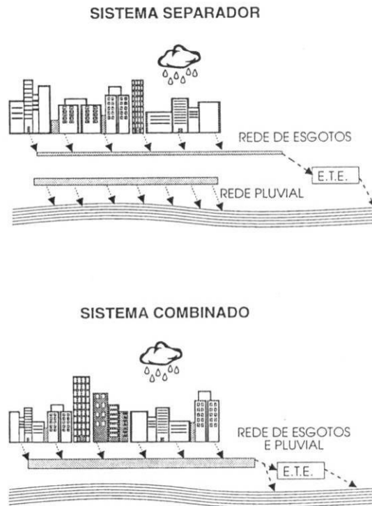
Figura 2.9 – Sistemas de esgotamento separador e combinado
