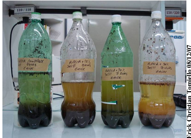
Figura 5.31 – Garrafas tipo PET utilizadas no ensaio de solubilização dos resíduos do desarenador da ETE 02 Sul
