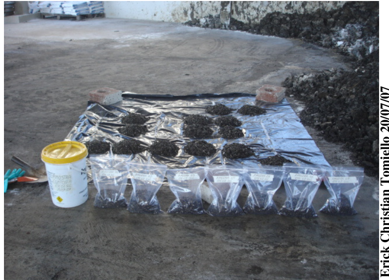
Figura 4.8 – Amostras acondicionadas para transporte e ensaios de laboratório dos resíduos do desarenador da ETE 02 Sul
