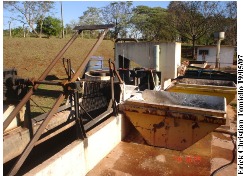
Figura 5.3 – Gradeamento grosseiro e mecanizado – ETE 01 Norte
