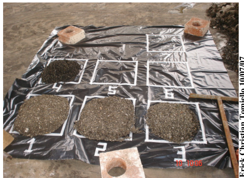
Figura 4.2 – Secagem das amostras de resíduos do desarenador da ETE 02 Sul
