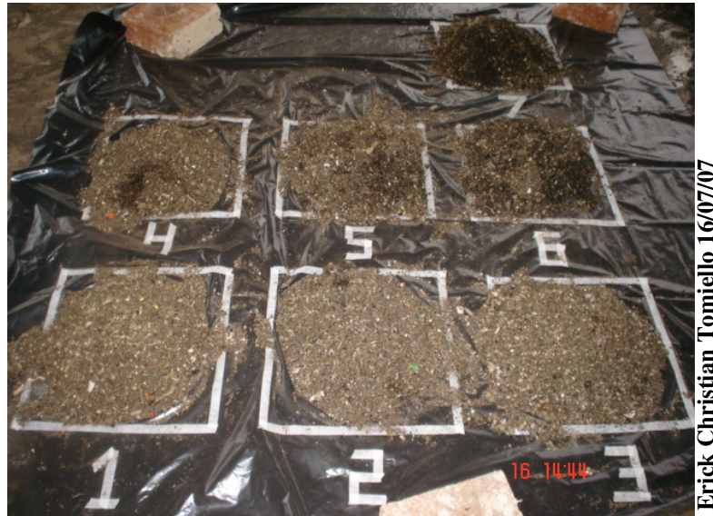
Figura 4.4 – Amostras 6 e 7 dos resíduos do desarenador da ETE 02 Sul com umidade elevada (cor escura)
