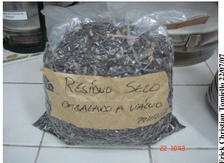
Figura 4.11 – Amostra composta dos resíduos do desarenador da ETE 02 Sul seca e embalada a vácuo para ensaio de granulometria
