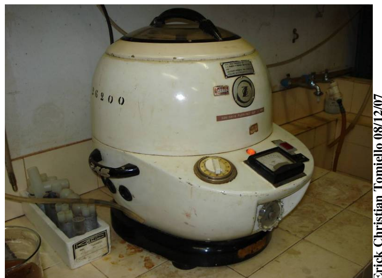
Figura 5.32 – Equipamento de centrifugação utilizado no extrato solubilizado dos resíduos do desarenador da ETE 02 Sul
