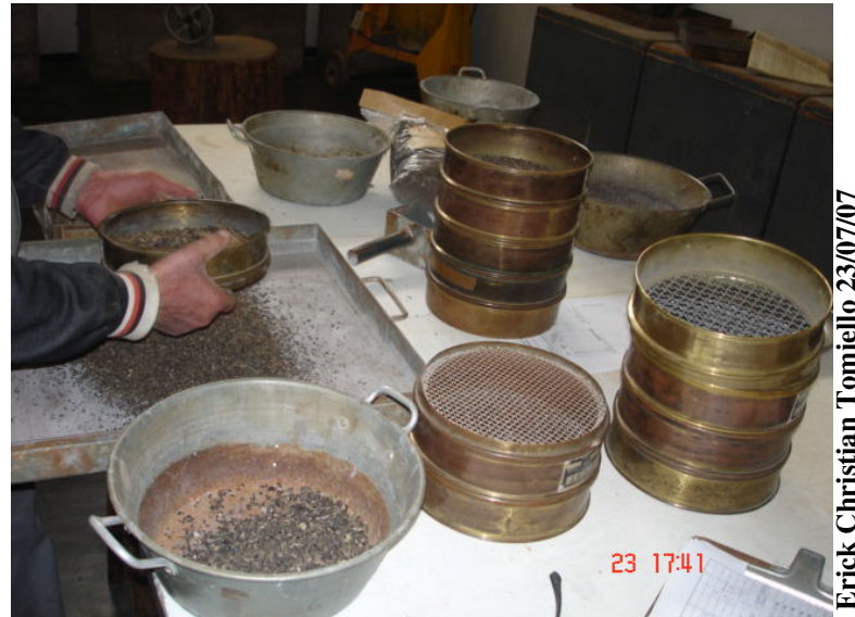
Figura 4.13 – Ensaio de granulometria - separação das quantidades retidas em cada peneira
