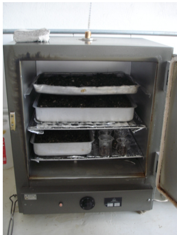
Figura 4.10 – Amostra composta dos resíduos da ETE 02 Sul secando em estufa
