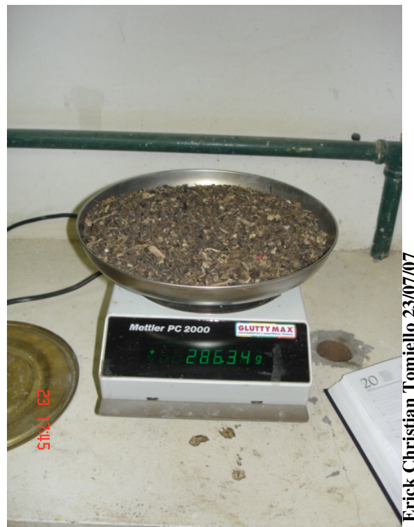
Figura 4.14 – Ensaio de granulometria - pesagem de fração retida em uma peneira
