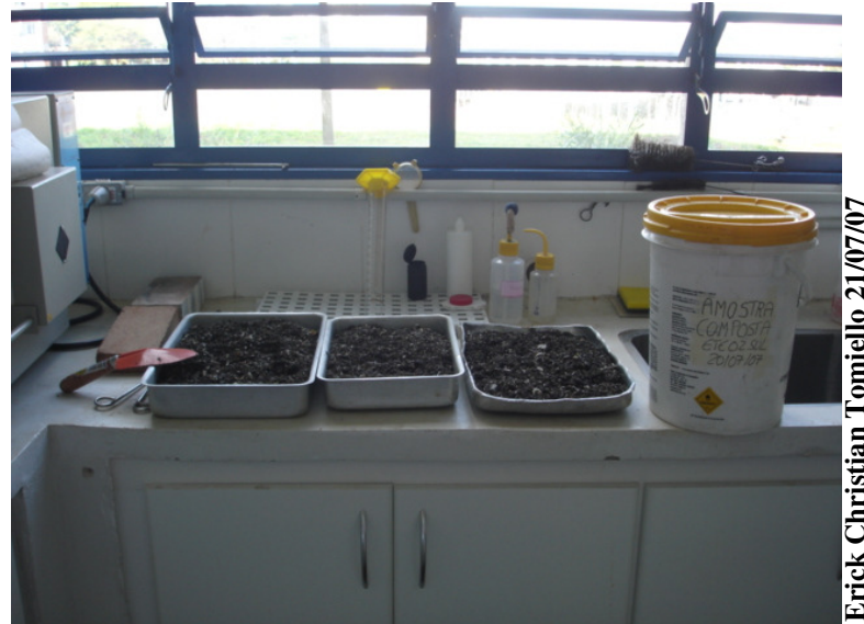
Figura 4.9 – Amostra composta dos resíduos do desarenador da ETE 02 Sul acondicionada em bandejas para secagem em estufa
