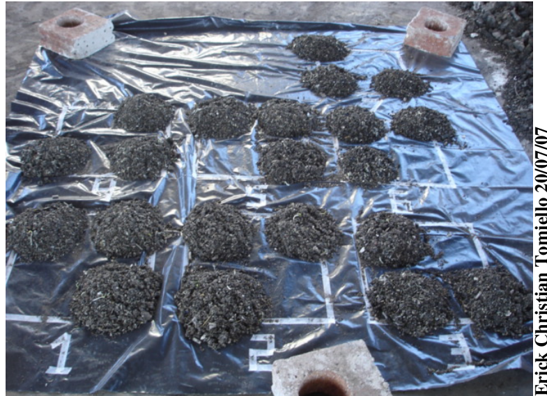
Figura 4.7 – Coleta alternada no sentido anti-horário de parcela das amostras para a composição da amostra composta dos resíduos do desarenador da ETE 02 Sul
