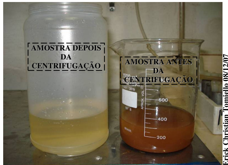
Figura 5.33 – Amostra antes e depois da centrifugação do extrato solubilizado dos resíduos do desarenador da ETE 02 Sul
