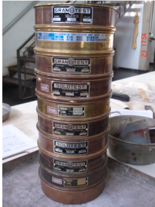
Figura 4.12 – Conjunto de peneiras circulares com malha quadrada montado com fundo
