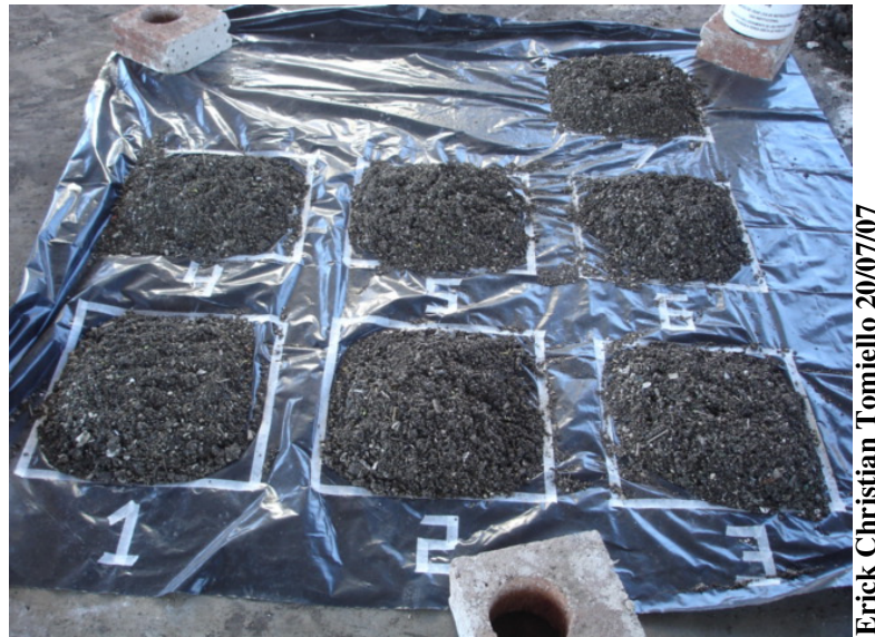
Figura 4.5 – Amostras dos resíduos do desarenador da ETE 02 Sul após 8 dias de secagem natural
