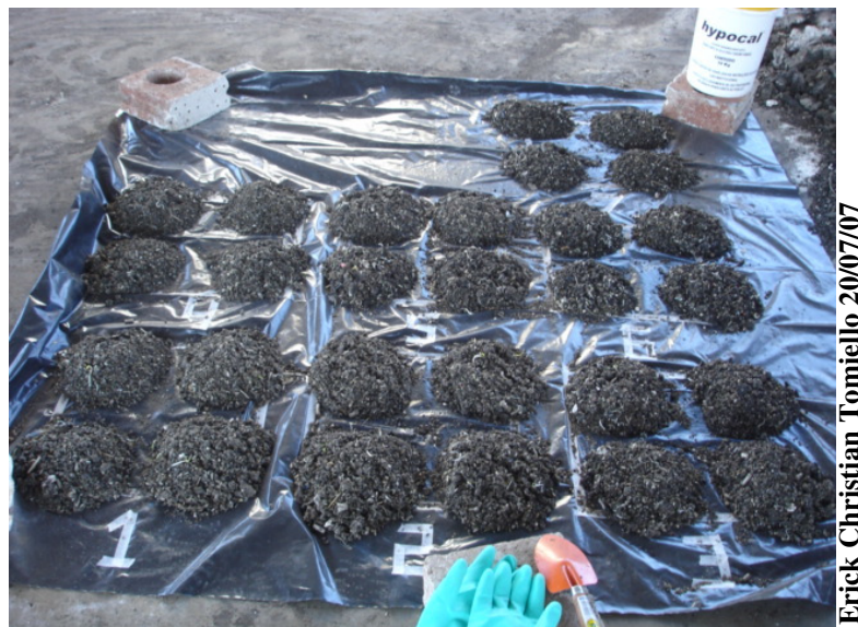
Figura 4.6 – Quarteamento das amostras dos resíduos da ETE 02 Sul
