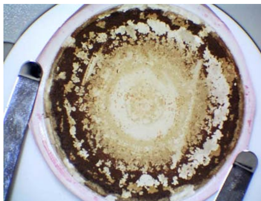
FIGURA 4.12 – Membrana após experimentos de deposição e limpeza.
