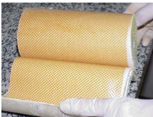
FIGURA 3.8 - Membrana utilizada nos ensaios de limpeza
