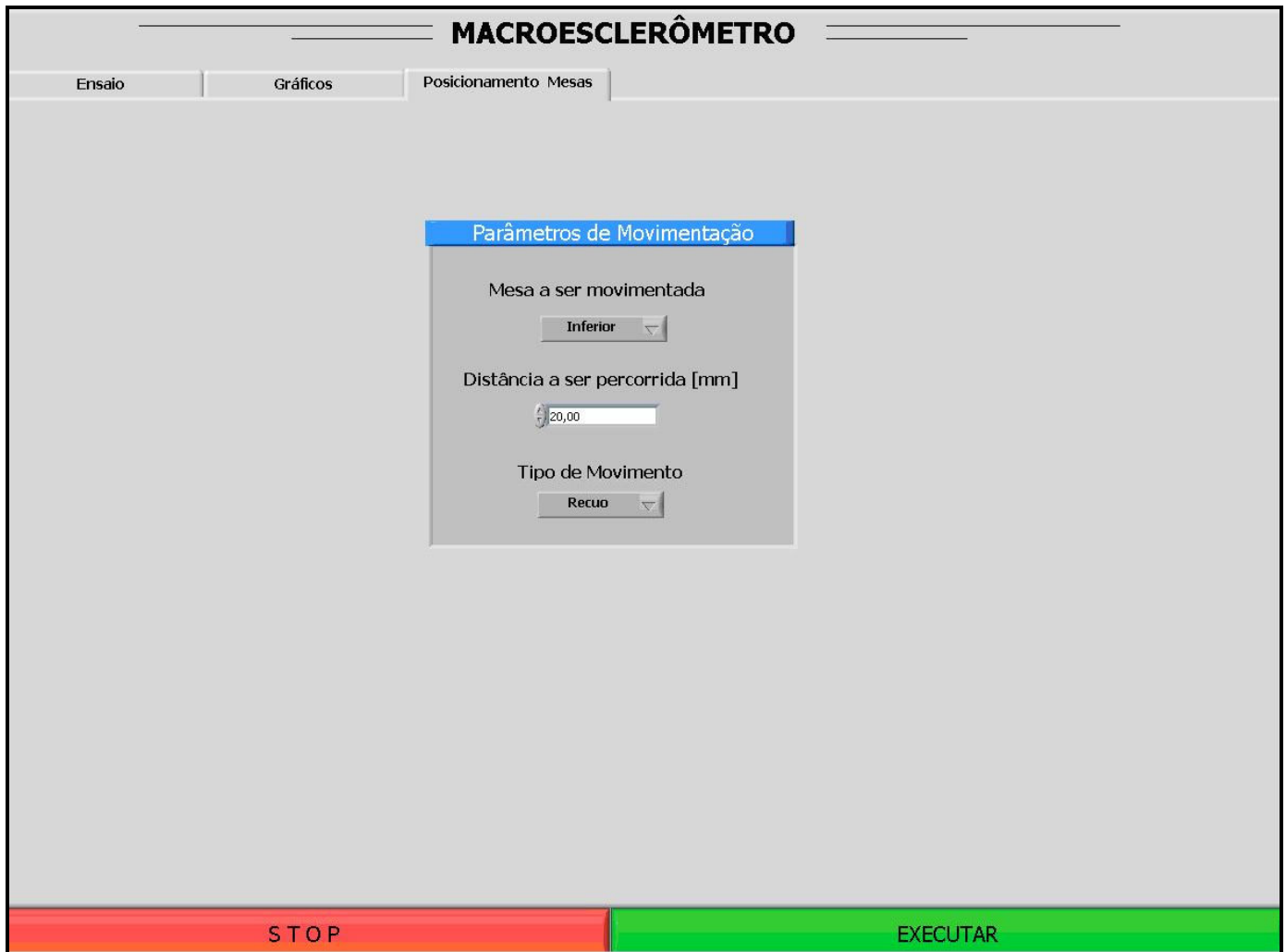
Figura 2.14: Interface utilizada para fornecimento de dados para movimentação da mesa superior ou inferior.
