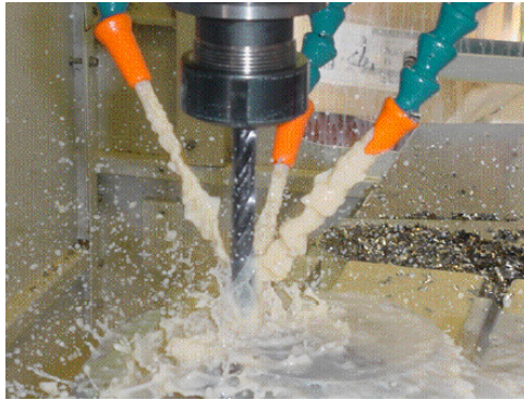
Figura 2.33 – Aplicação por jorro em 3 bicos do fluido de corte semi-sintético, vazão total de 1230 l/h
