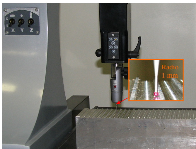
Figura 3.7 - Medição da largura dos canais usando uma maquina de coordenadas
