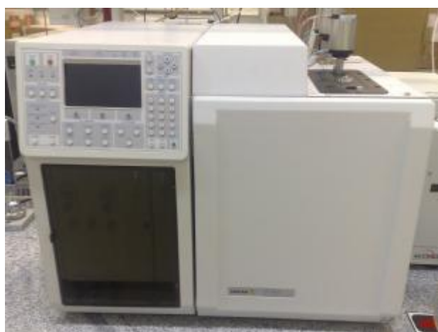
Figura 4.3. Cromatógrafo gasoso GC-3800, VARIAN.
