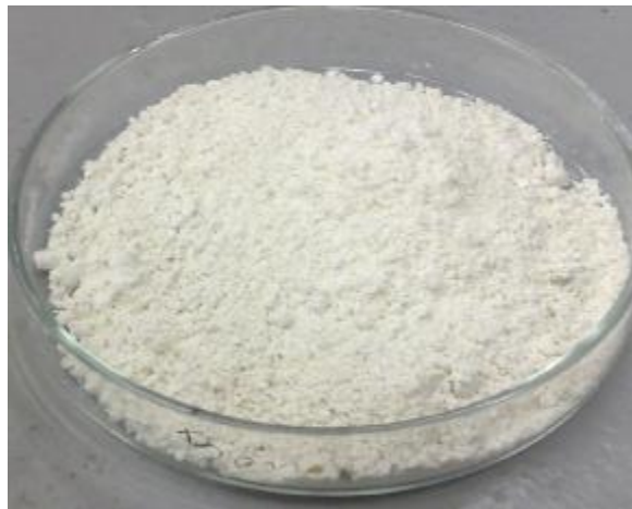
Figura 2.8. Diatomita em forma de pó com granulometria de 300#.
