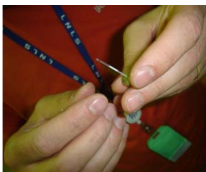
(a) detalhe do capilar com a suspensão sendo montada no pino metálico
