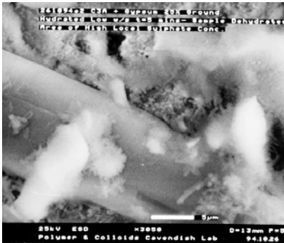
Figura 2.32: cristais de etringita curtos e espessos desenvolvendo-se próximo a grandes cristais de gipsita. 5 minutos de hidratação. a/c=5 . 25% de gipsita. Barra de escala=5 \mu\text{m} .
