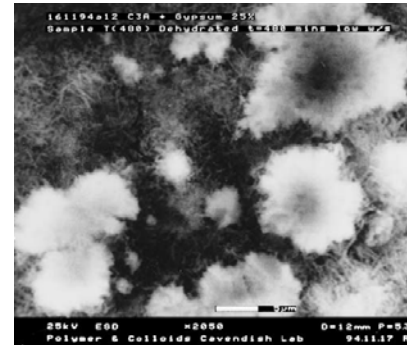
Figura 2.34: placas irregulares de monossulfoaluminato formados a partir de agulhas de etringita. 8 horas de hidratação. a/c=5 . 25% de gipsita. Barra de escala=5 \mu\text{m} .
