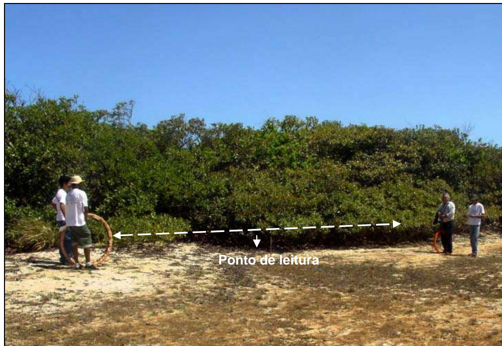
Foto 7.1. Leituras com a configuração de dipolos horizontais (bobinas verticais) realizadas nas paleodunas, próximas ao Porto do Pecém, no Município de São Gonçalo do Amarante-Ce.
