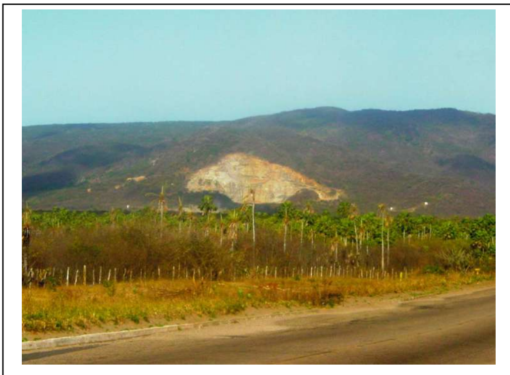
Foto 5.1 - Complexo serrano do Camará, Serra da Conceição e Serra da Taquara mostrando na sua parte norte, perpendicular à direção E-W um corte de exploração de britas para construção civil em migmatitos e/ou gnaisses associados, levemente migmatizados, através do sistema de desmonte por bancadas na localidade denominada Serrote Mineiro.
