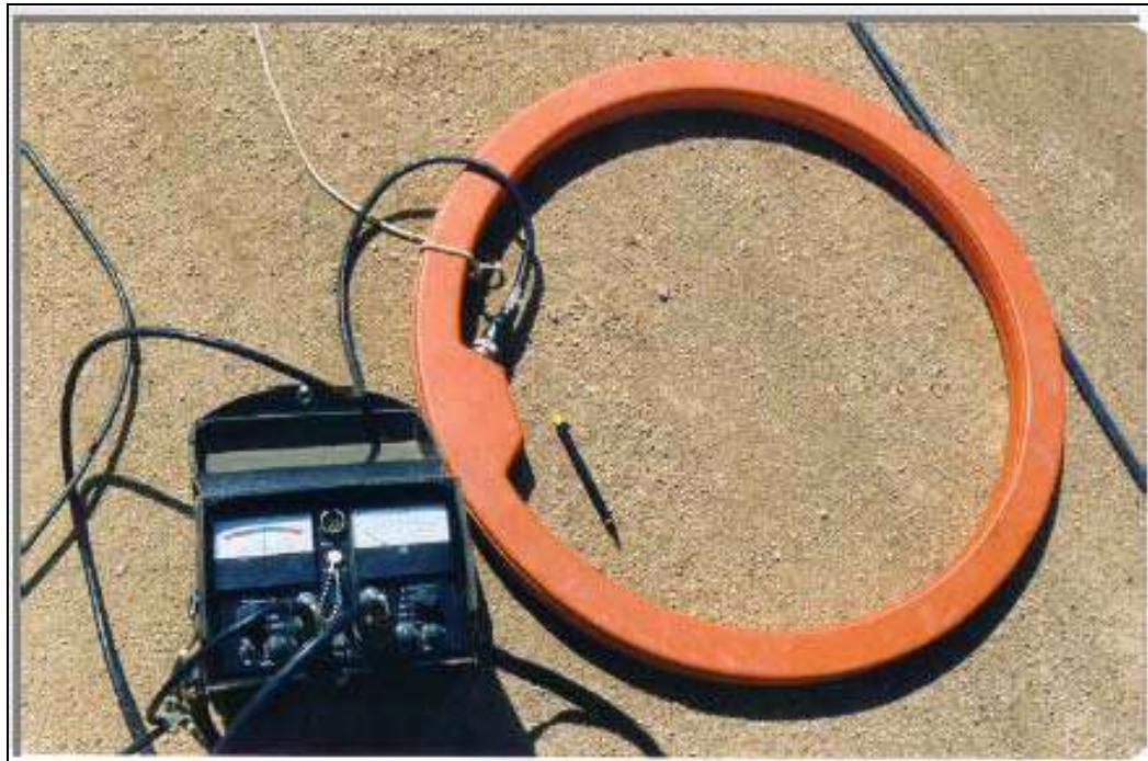
Foto 7.2 – Bobina Receptora e console do receptor (associado). A posição horizontal da bobina sobre o solo exemplifica nesta posição que o dipolo está na vertical.
